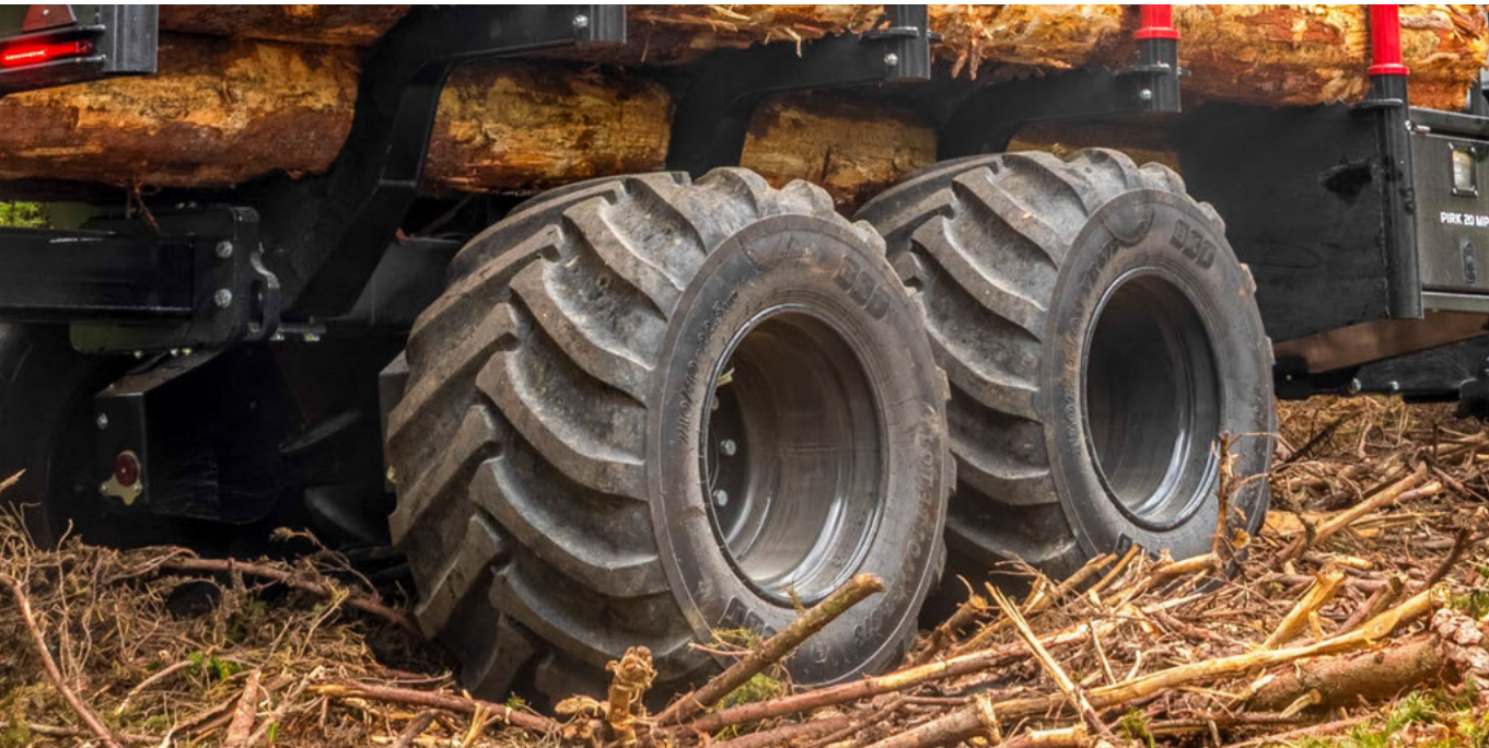
Essieu bogie avec une plage de pivotement jusqu'à ± 20°
