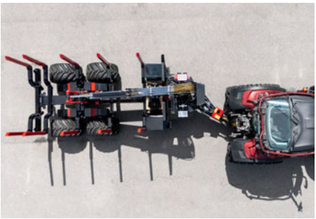
La remorque forestière peut être décalée latéralement jusqu'à 104 cm avec le timon
