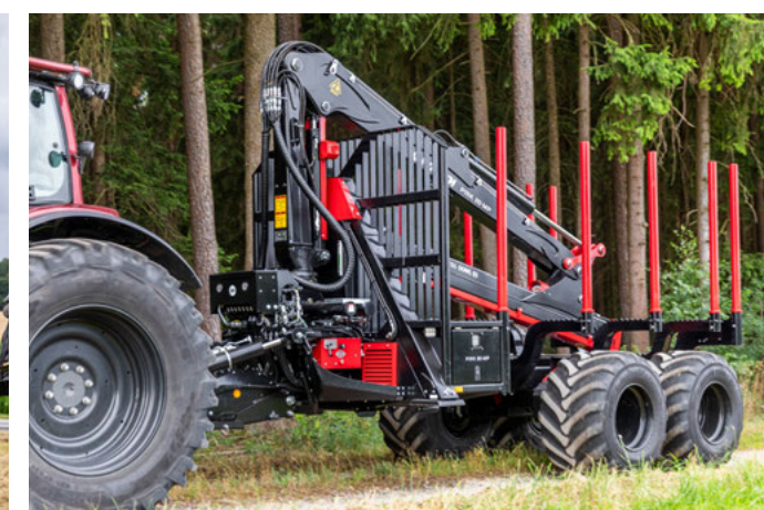
Sur les chemins de champ et de forêt, la remorque est relevée par le timon hydraulique afin d'augmenter la garde au sol
