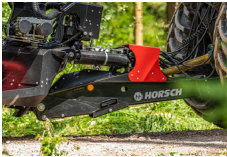
En position basse, le déport latéral du véhicule est empêché par la butée mécanique du vérin
