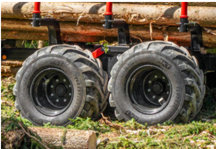
Pneumatiques jusqu'à 710 mm de largeur et 117 cm de diamètre
