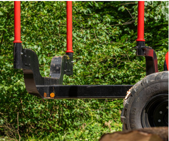
Extension arrière complètement déployée
