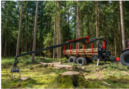
IB 9800.L10 avec une portée allant jusqu'à 10 m et une capacité de levage de 2,2 t pour une portée de 4 m
