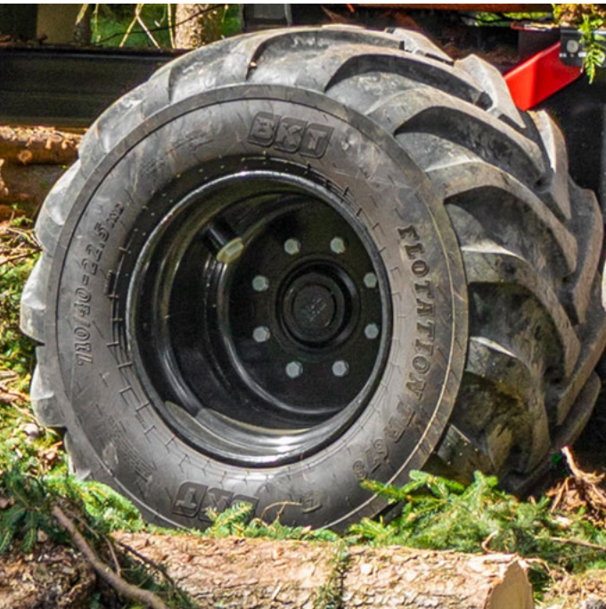
Entraînement des roues BlackBruin sur l'essieu arrière d'une remorque forestière Pirk 20 MP
