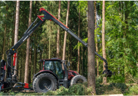
La plage de pivotement jusqu'à 400° permet également de travailler devant ou à côté du tracteur
