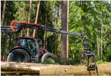
Toutes les grues sont équipées d'une double extension télescopique
