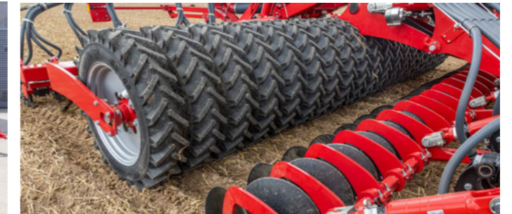
Packer à pneus pour un rappui homogène sur toute la largeur
