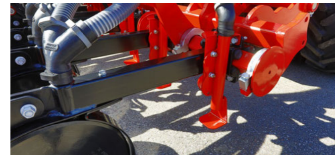
MiniDrill PPF avec éclateurs
