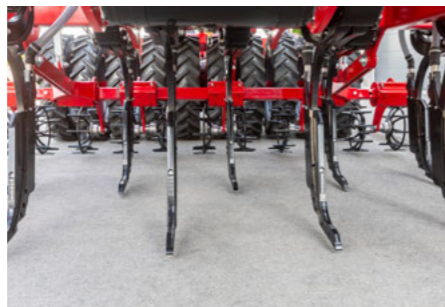
La pointe ULD ne remonte pas d'humidité
