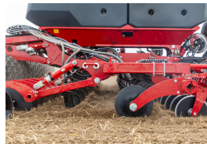
Focus pour l'ameublissement profond combiné à un apport d'engrais localisé
