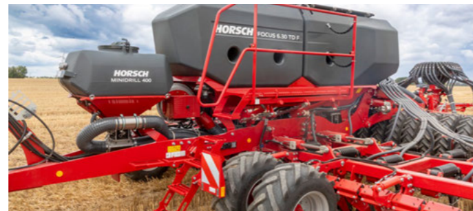
MiniDrill G&F faisant office de troisième cuve
