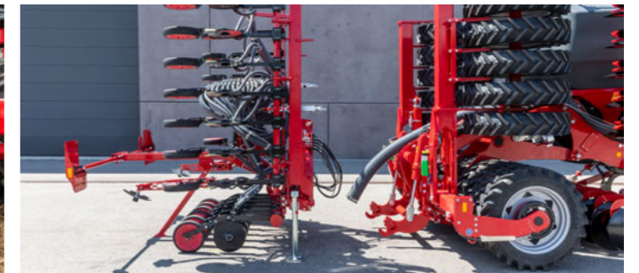
Rampes de semis facilement interchangeables grâce à l'attelage 3 points
