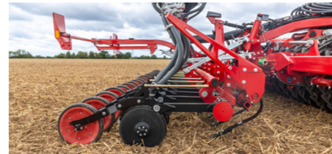
SeedFrame avec élément ParaDisc avec interrang de 30 cm, Crossbar et tête de répartition RowControl
