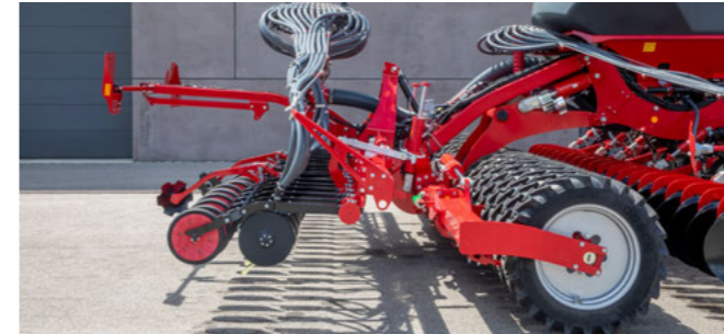
Packer à pneus pour un rappui homogène sur toute la largeur
