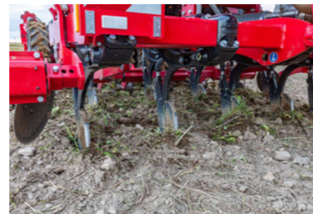
La pointe ULD fissure le sol et dépose l'engrais
