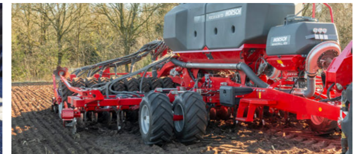
MiniDrill PPF – le troisième produit est appliqué sur l'horizon superficiel via des éclateurs
