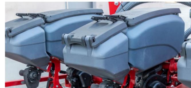
Cuve de microgranulés avec un volume de 18 litres
