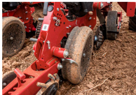
La roue RID réduit le compactage du sol au niveau du sillon sur sols très durs ou en semis direct
