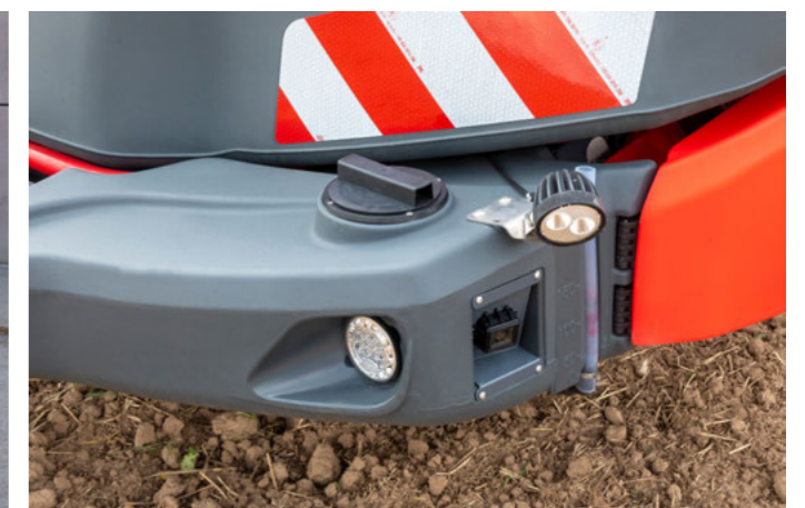
Réservoir d'eau claire avec système de caméra et éclairage frontal
