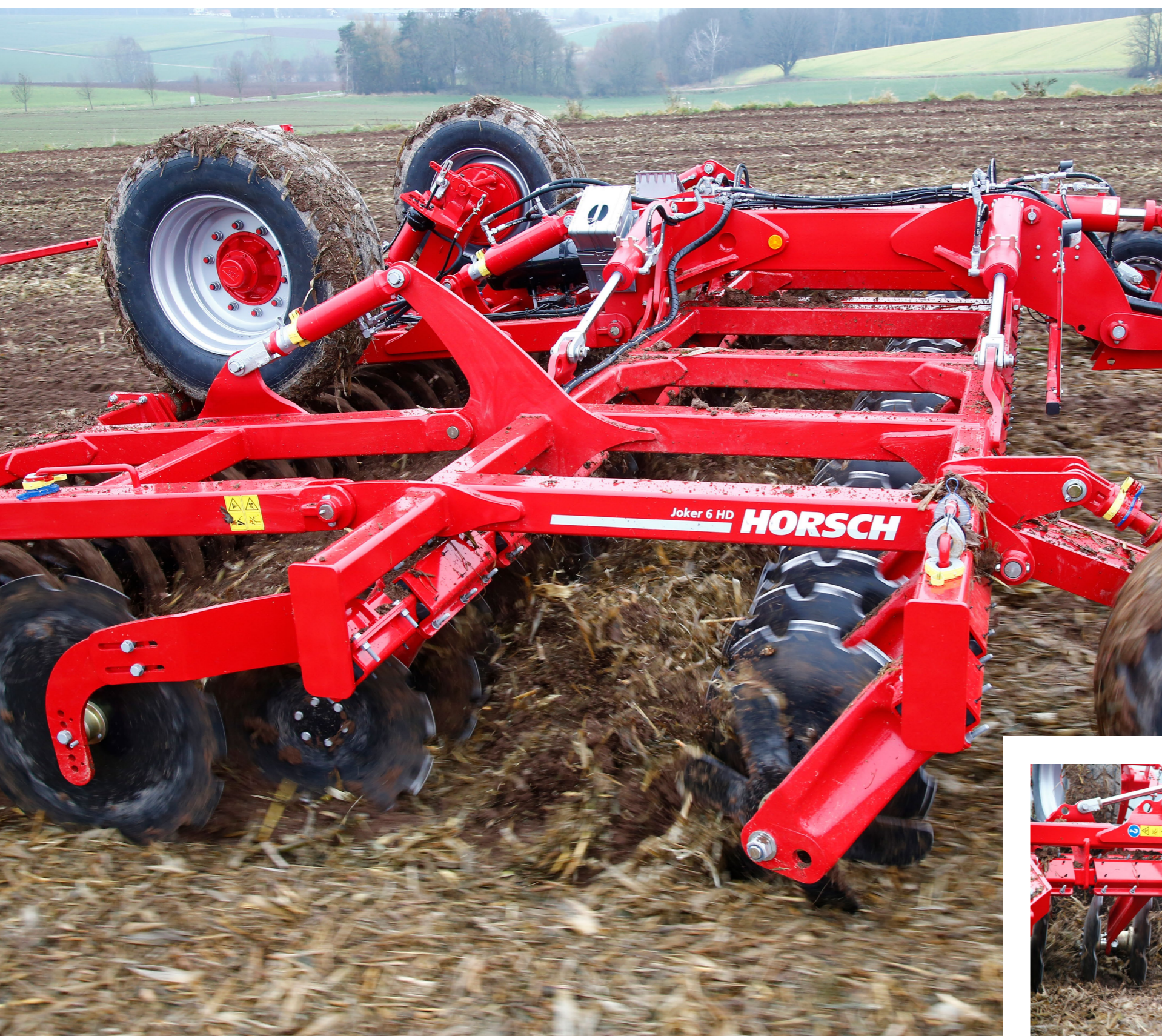
Supports larges fixés sur le châssis pour un guidage précis des disques dans le sol
