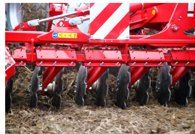
Supports larges fixés sur le châssis pour un guidage précis des disques dans le sol
