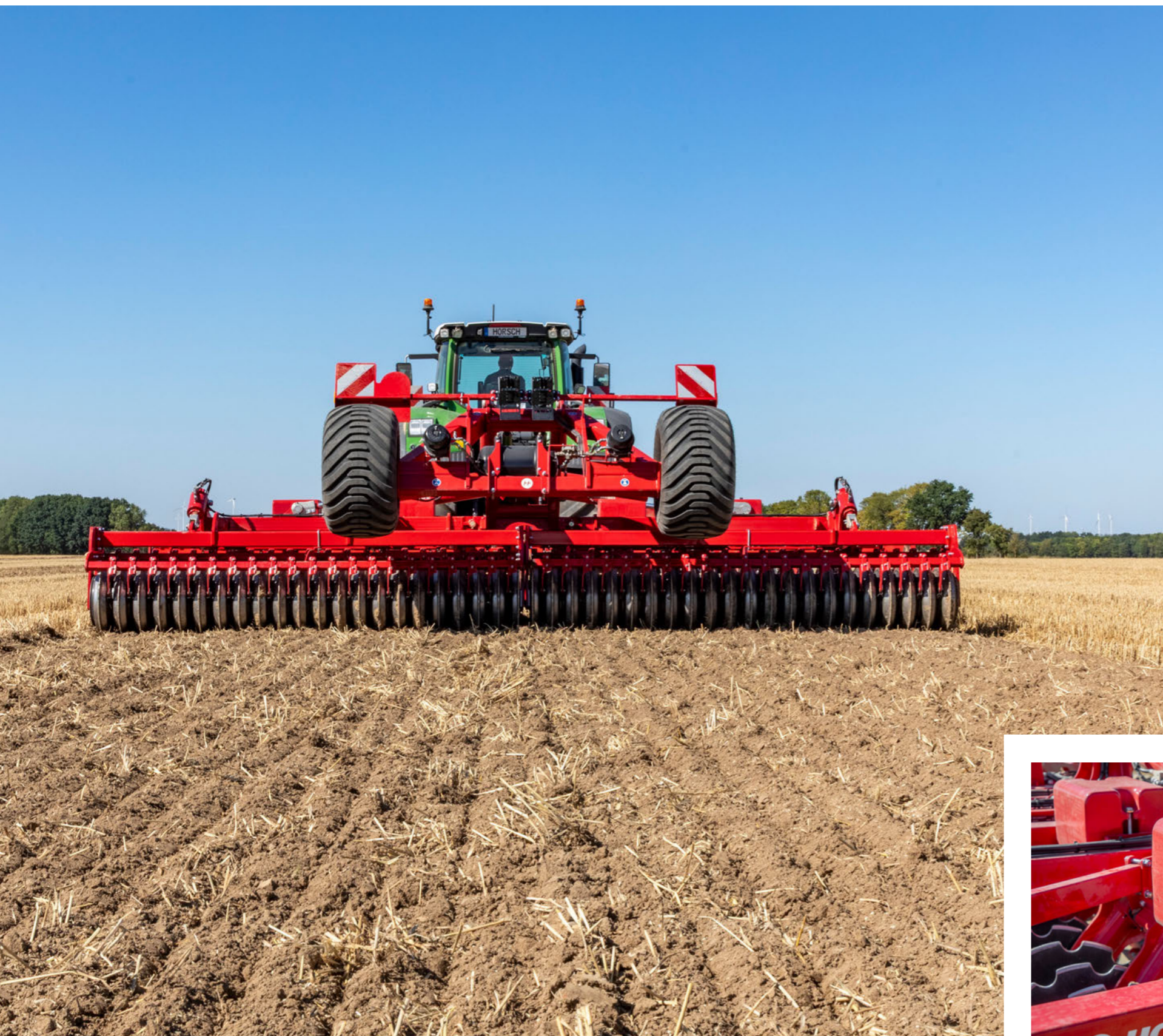
Masses supplémentaires pour une répartition optimale des charges et une pénétration fiable dans le sol
