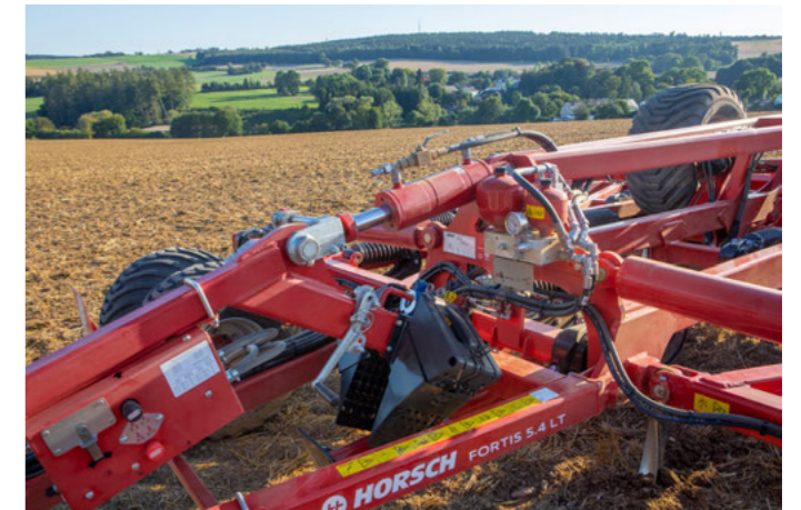
Système de report de charge sur l'essieu arrière du tracteur intégré sans points de couplage supplémentaires
