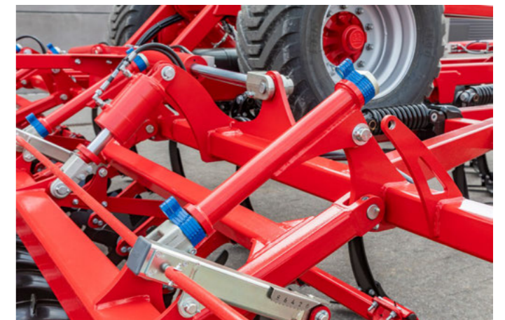
Réglage de l'angle de tous les rouleaux en version double afin de pouvoir réagir rapidement en cas de conditions changeantes
