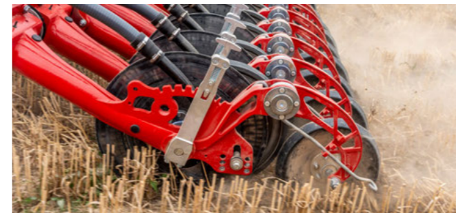
Structure de la rampe de semis sur une seule poutre pour un placement uniforme de la graine
