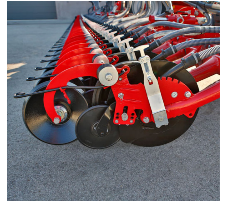
Plombage parfait des graines grâce à la roulette en caoutchouc
