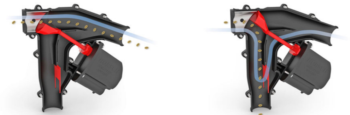
Clapet RowControl en position ouverte: semence acheminées vers l'élément semeur
