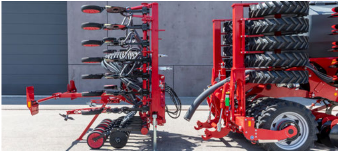
Einfacher Säschienenwechsel dank 3-Punkt Anbau
