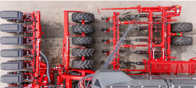
Reifenpacker direkt hinter dem Lockerungszinken
