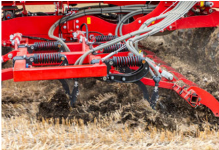
LD Schar/LD Plus Schar – Durchmischung des gelockerten Bereichs
