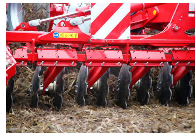
Breite Scheibenlagerung am Rahmen für exakte Führung der Scheiben im Boden
