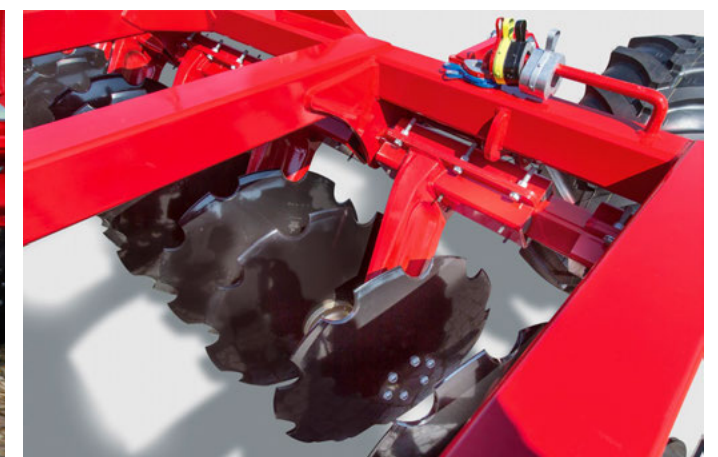
Großdimensionierte Scheiben mit einem Durchmesser von 62 cm
