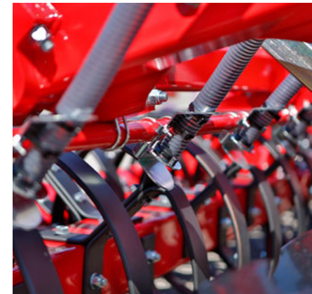
Särschiene für die Aussaat von Zwischenfrüchten in einem Arbeitsgang
