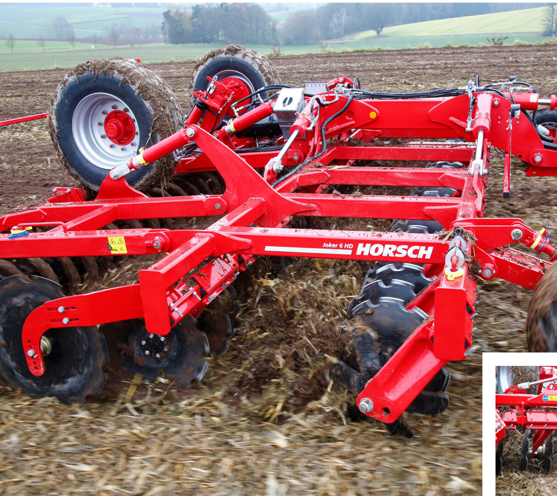
Breite Scheibenlagerung am Rahmen für exakte Führung der Scheiben im Boden
