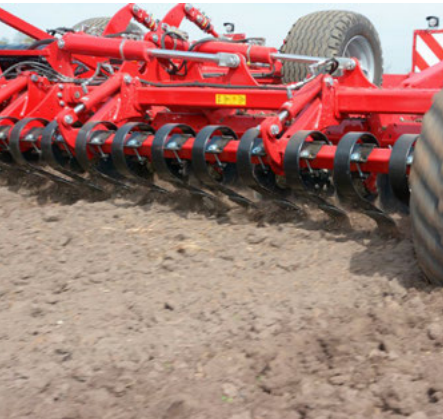
Optional mit Crossbar für einen zusätzlichen Ebnungseffekt
