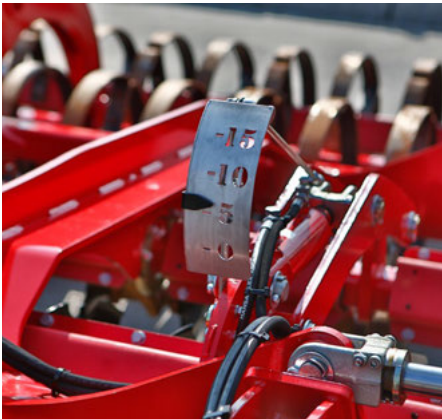
Hydraulische Tiefenverstellung zur komfortablen Einstellung der Maschine
