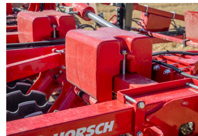
Zusatzgewichte zur optimalen Gewichtsverteilung und zum sicheren Eindringen in den Boden
