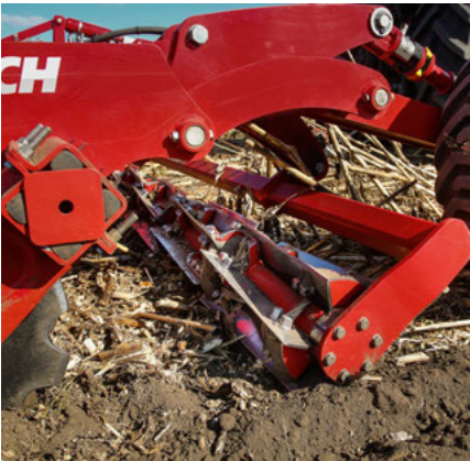
Optional mit hydraulisch vorgespannter Messerwalze für einen zusätzlichen Zerkleinerungseffekt.
