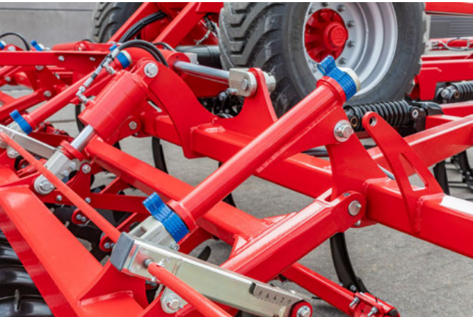
Packerwinkelverstellung für alle Doppelpacker, um schnell auf wechselnde Bedingungen reagieren zu können
