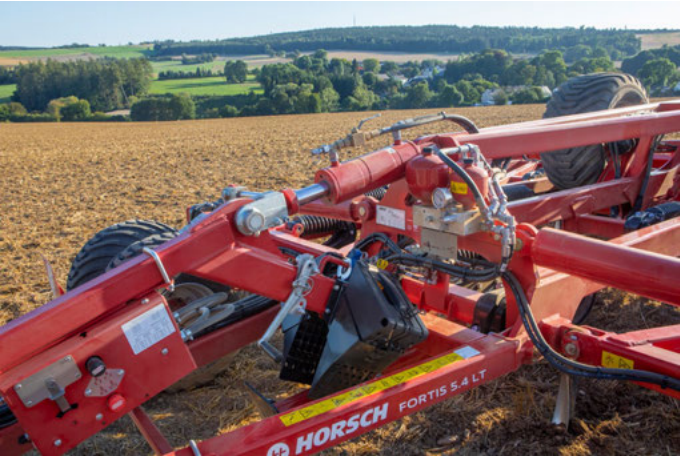
Integrierte Lastübertragung auf die Hinterachse des Schleppers ganz ohne zusätzliche Koppelpunkte
