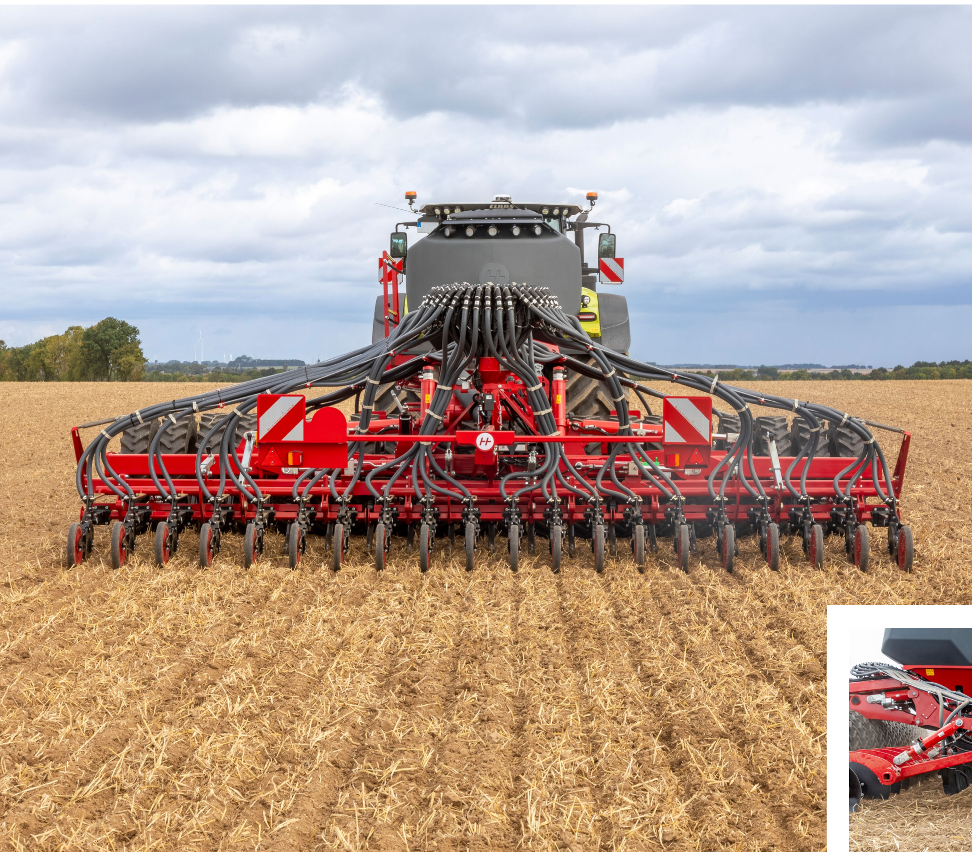
Focus für die tiefe Lockerung mit gleichzeitiger Depotdüngung
