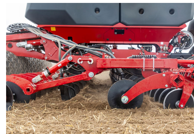
Focus für die tiefe Lockerung mit gleichzeitiger Depotdüngung
