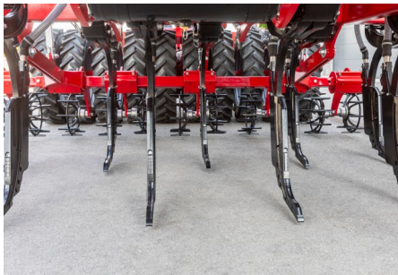
ULD Schar holt keine Feuchtigkeit aus der Tiefe
