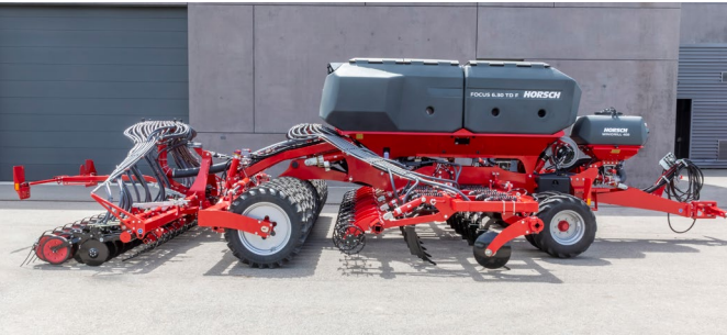
Großdimensionierter Reifenpacker für einen leichten Lauf
