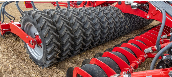
1-reihiger Reifenpacker für gleichmäßige Rückverfestigung
