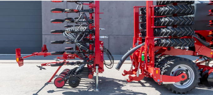
Einfacher Sädschienenwechsel dank 3-Punkt Anbau
