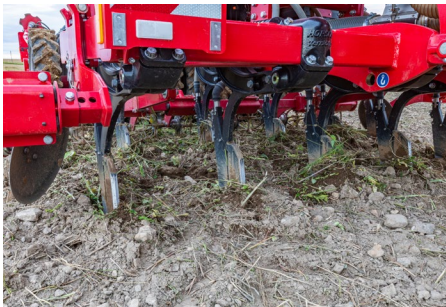
ULD Schar öffnet den Boden und legt Dünger ab
