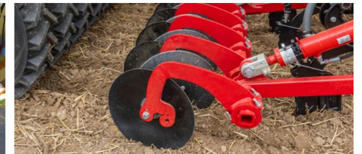
!!! NO CONTENT IN PCM !!! 666bdd0e-bd03-427f-93d8-89d75b7ff7c3 Former content: Scheibeneinebnung für das sichere Schließen des gelockerten Streifens
