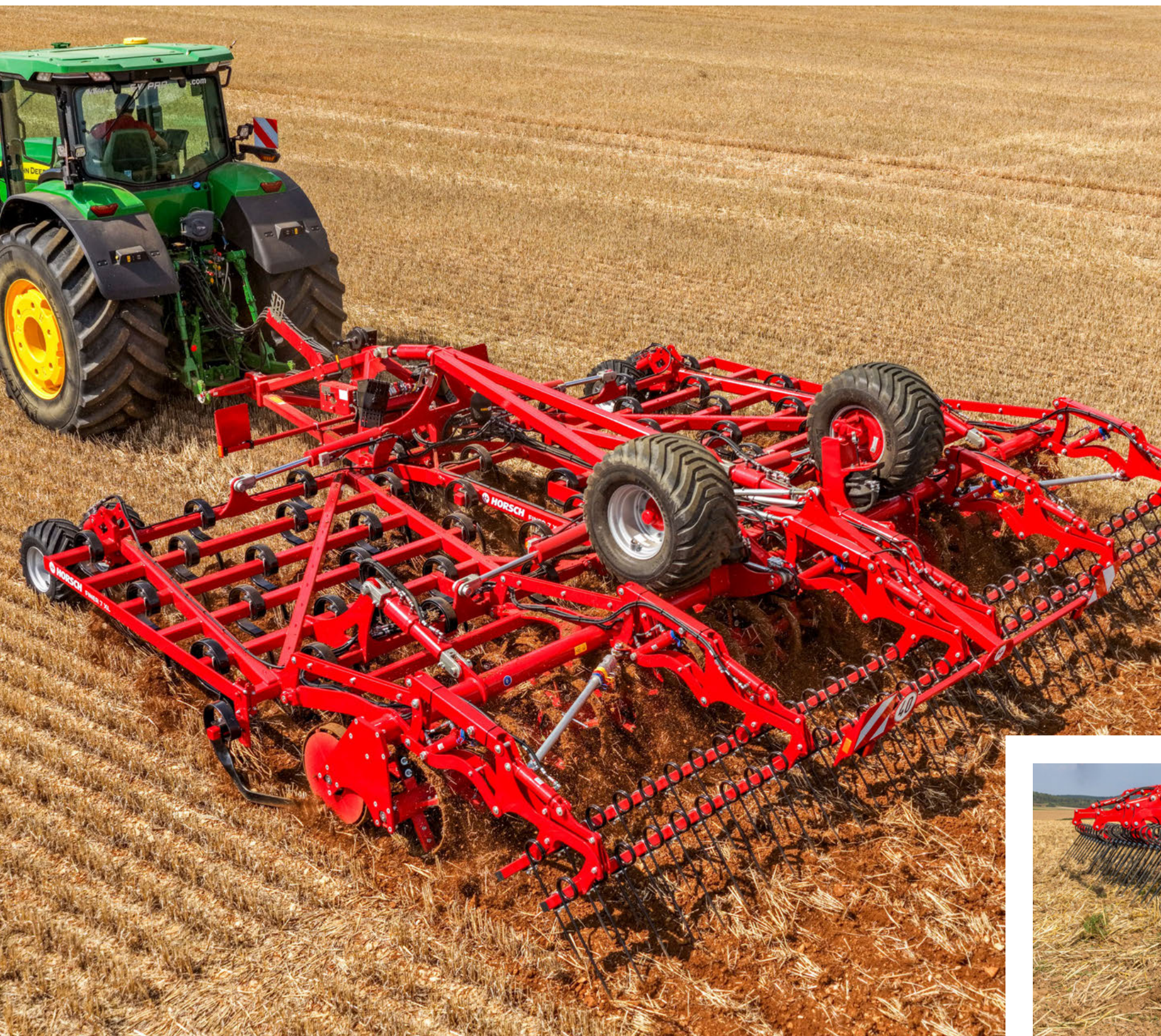
Striegel legt enterdete Unkräuter auf der Oberfläche a
