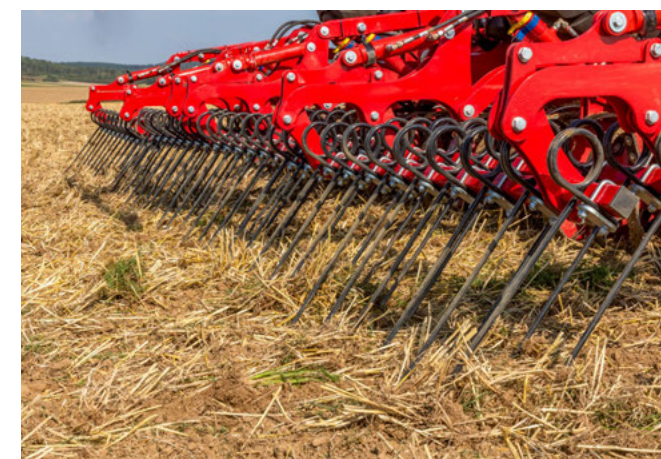
Striegel legt enterdete Unkräuter auf der Oberfläche a
