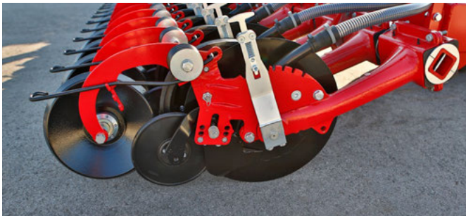
SingleDisc – perfekte Boden Anpassung dank Tiefenführungsrad
