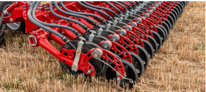
Einzeltiefengeführtes Einscheibenschar NarrowDisc
