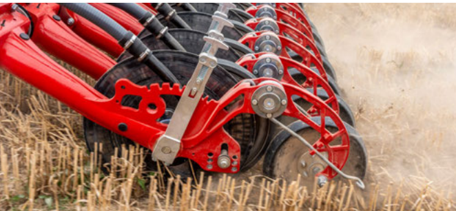
1-balkiger Aufbau für eine gleichmäßige Ablage
