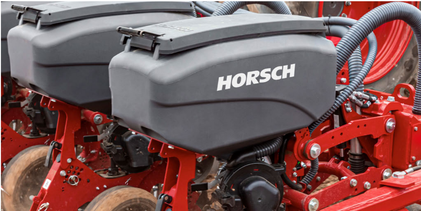
Tramoggia per unità di fila con volume di 70 l
