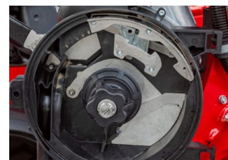
Il separatore universale non deve essere regolato
