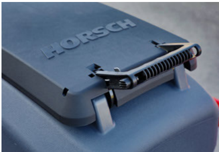
Chiusura della tramoggia di fila
