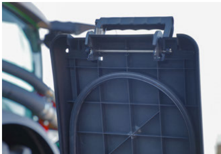
Guarnizione del coperchio della tramoggia dell'unità di semina
