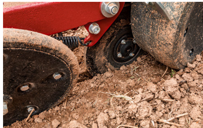
Il rullo di presa è fondamentale per un buon contatto tra il grano e il suolo
