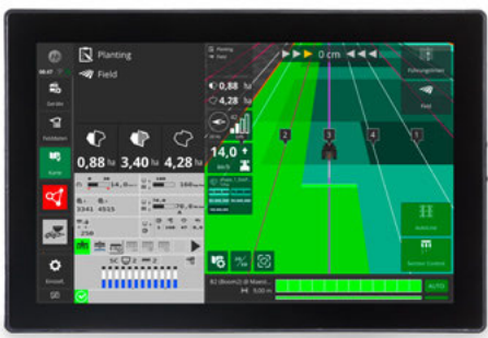
Con la tecnica di semina a chicco singolo e HORSCH AutoLine, è possibile seminare le corsie di guida in modo completamente flessibile e indipendente dalla direzione di marcia, supportato da GPS
