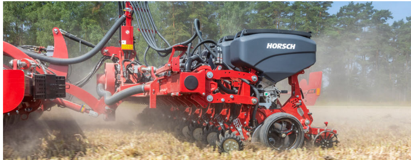
Con l'attacco del carro seminatore è possibile raggiungere una pressione del coltro fino a 350 kg
