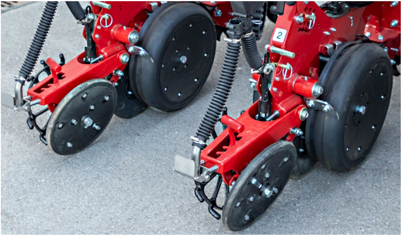
Unidad de microgranulado en la hilera con ambos puntos de aplicación
