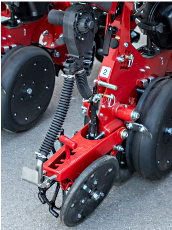
Unidad de microgranulado en la hilera con ambos puntos de aplicación
