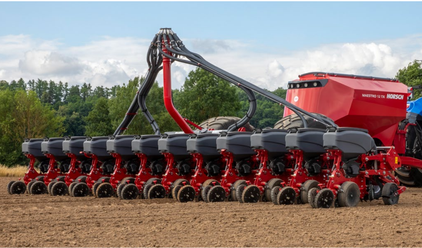
Maestro 12 TX con un espacio entre hileras de 75 cm durante la siembra de maíz
