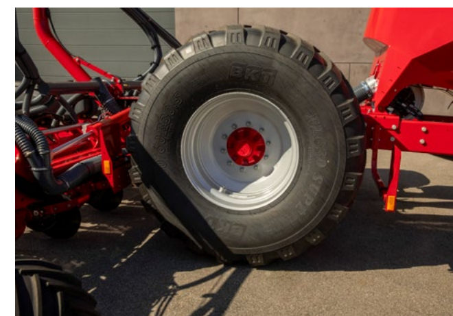
Equipado con neumáticos de gran volumen 750/60 R 30.5 para una siembra que protege el suelo
