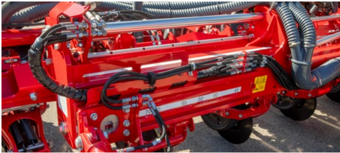
Ajuste del tope de las alas y ajuste de las ruedas de soporte
