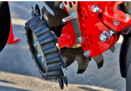
Estrellas desbrozadoras opcionales, flotantes con control de profundidad
