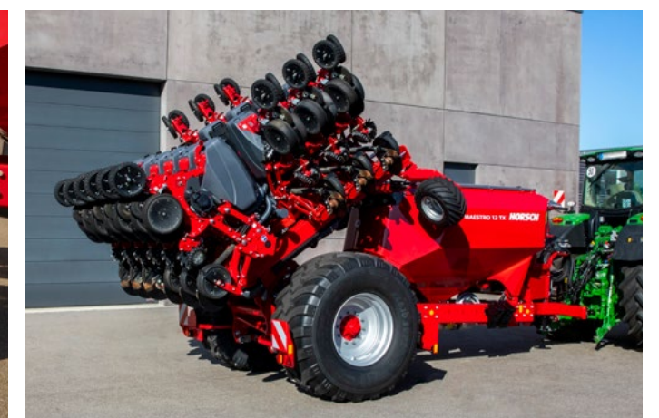
Maestro 12 TX en el transporte por carretera
