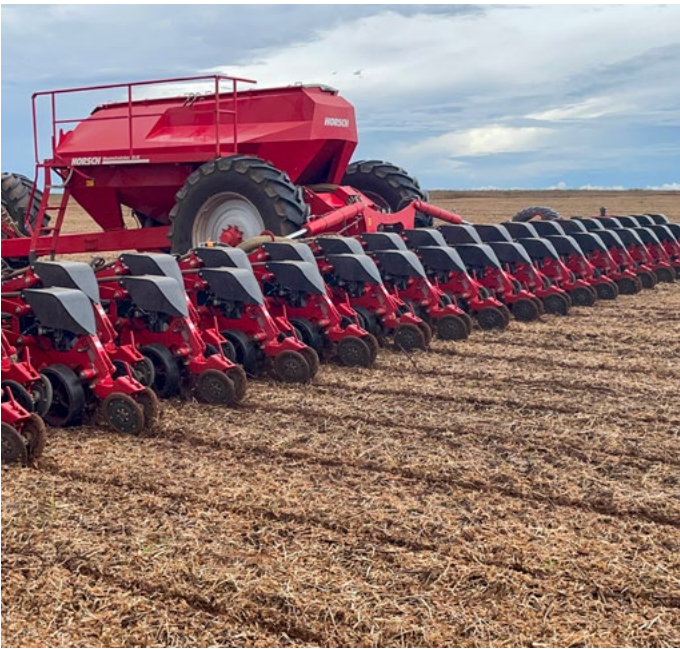
Qualidade do sulco de plantio evitando envelopamento
