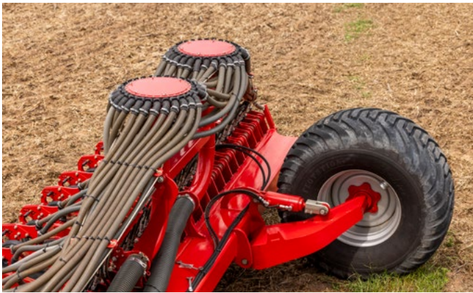
Sistema de distribuição com pressão positiva
