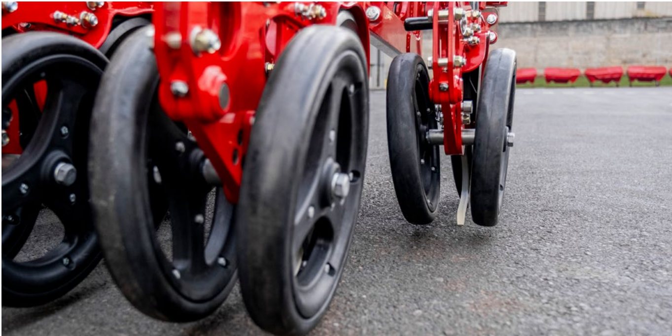
O finalizador de sulco da Dakar melhora o contato entre a semente e o solo, promovendo uma emergência mais uniforme.
