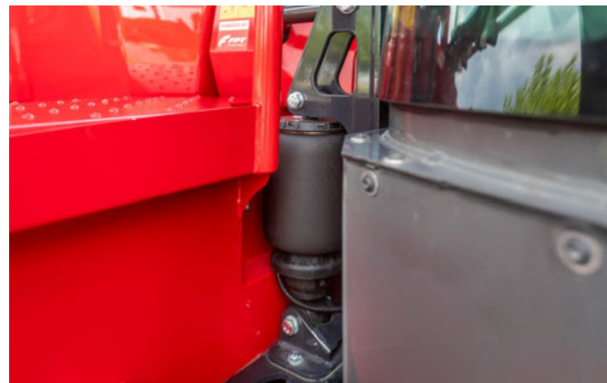
Pneumatické 4-bodové odpružení kabiny
