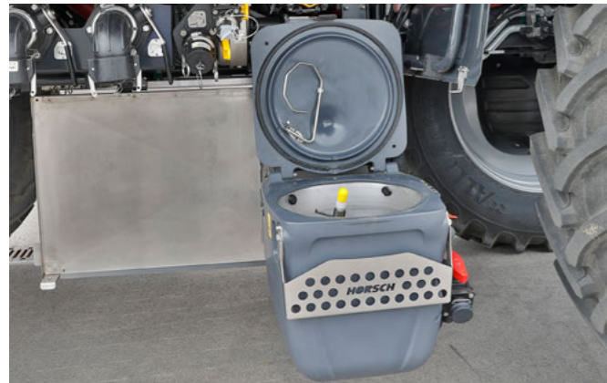
52 l nerezová přímichávací nádoba včetně přídatné míchací trysky
