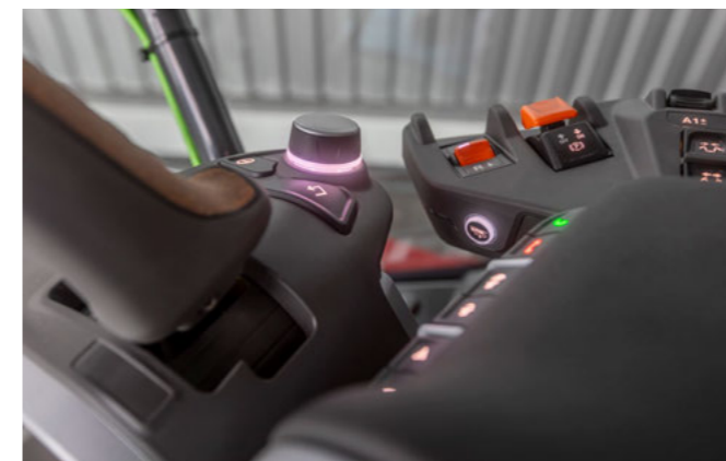
Bezpečné ovládání displeje A-sloupku: Funkce otáčení/stisknutí
