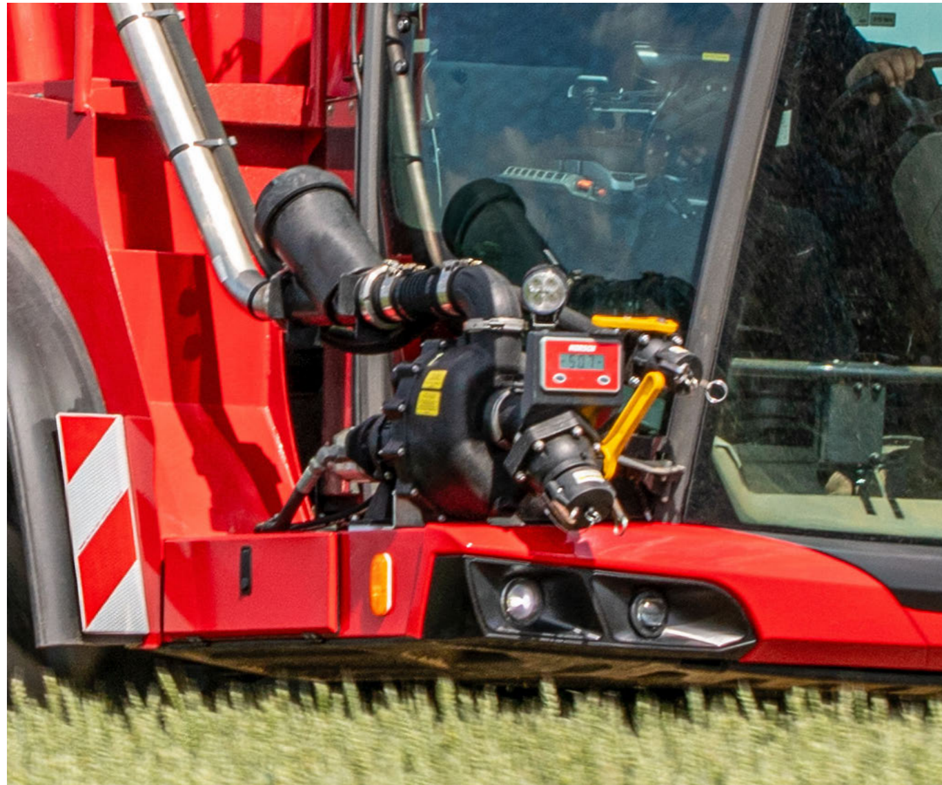
PowerFill plnicí čerpadlo s výkonem 1 000 l/min - 3" Camlock plnicí přípojka vpředu a displej
