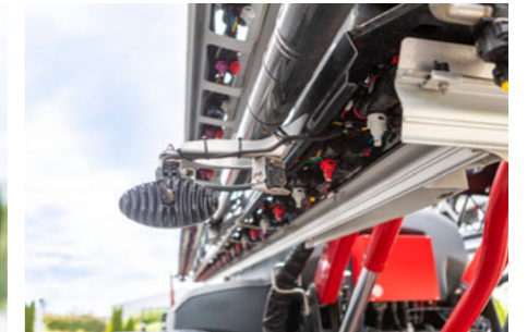
Kamera pro sledování trysek na NightLight držáku
