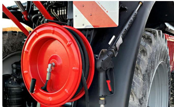
Hydraulicky poháněný vysokotlaký čistič
