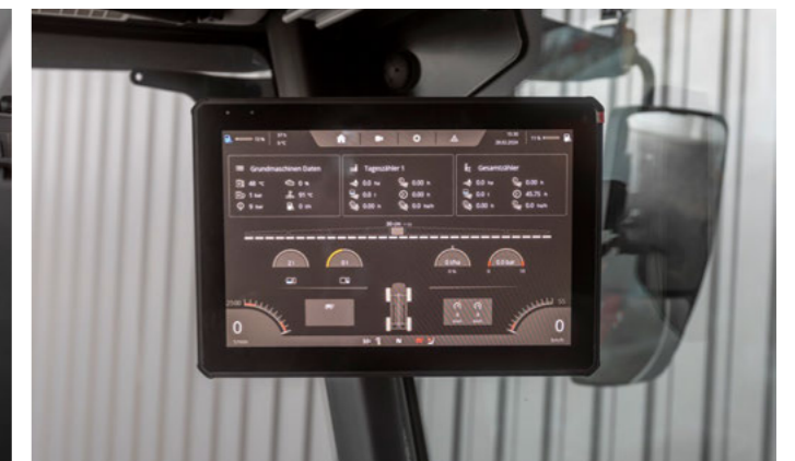
Sériový 12" displej s volně konfigurovatelným zobrazením na A-sloupku
