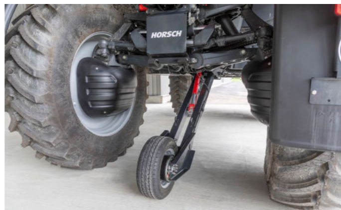
Hydraulická přídatná náprava pro jízdu po silnici je u Leeb 8.300 PT volitelná
