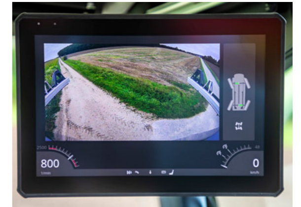
Vysoké rozlišení, automatické zobrazení zadní kamery na displeji A-sloupku
