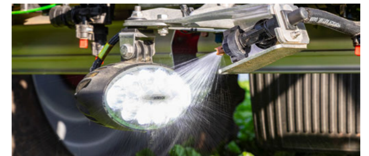
NightLight із автоматичним омиванням фар
