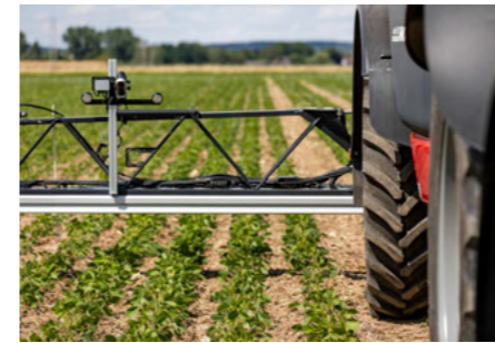
Високоточне керування причіпним обприскувачем з системою CultiCam
