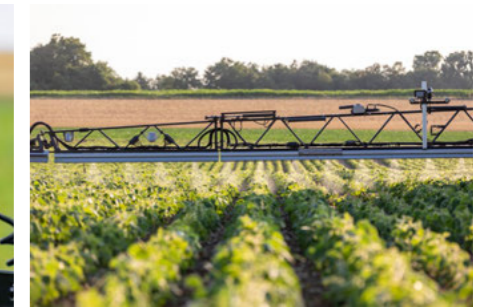
Ефективне стрічкове внесення препаратів з опційною системою керування за допомогою камер і точним веденням форсунок над рядками рослин
