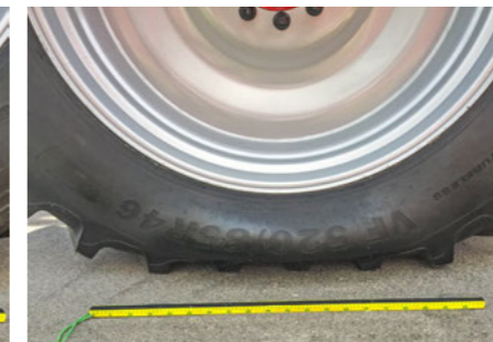
ATP Control — більша площа контакту із тиском у шинах 1,0 бар
