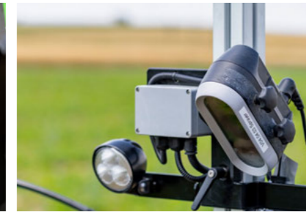
Керування за допомогою камери CultiCam з додатковим пакетом освітлення для роботи в умовах обмеженої видимості
