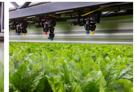
Пневматичне перемикання форсунок і секцій штанги
