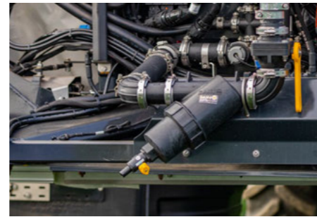
Другий напірний фільтр у центральній секції штанги
