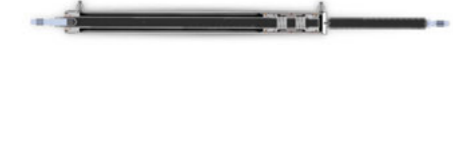
MotionControl для амортизації горизонтальних коливань крил штанги
