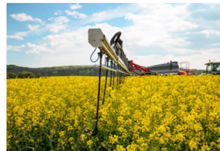
Системи для підлистового обприскування, наприклад, за допомогою Dropleg
