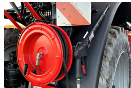
Мийка високого тиску з гідравлічним приводом
