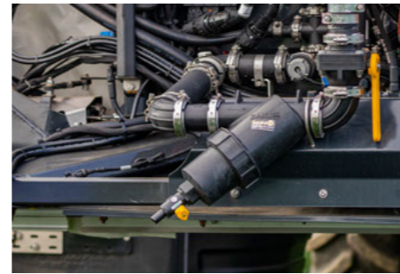
Второй напорный фильтр в средней части штанги
