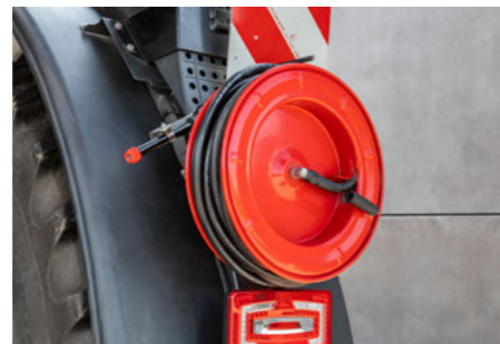
Шланг на специальной катушке для очистки внешних поверхностей
