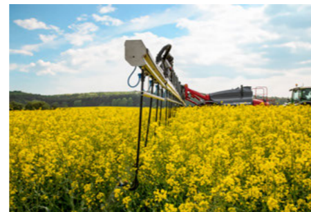
Системы подлистного опрыскивания (например, Droplegs)
