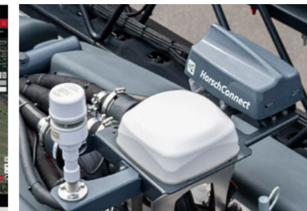
Объединение цифровых данных HorschConnect, GPS и метеостанции для оптимальной адаптации к текущим погодным условиям
