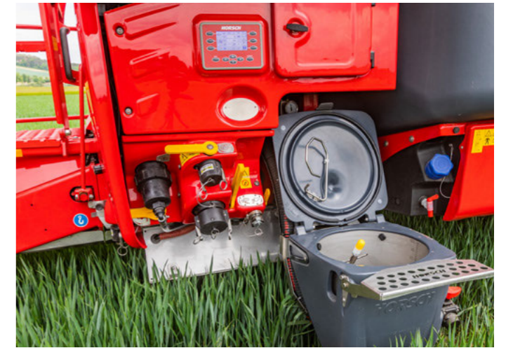
Заправочная станция из нержавеющей стали объемом 52 л с дополнительной ударной форсункой
