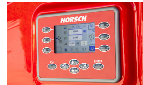
Внешний терминал управления CCS Pro
