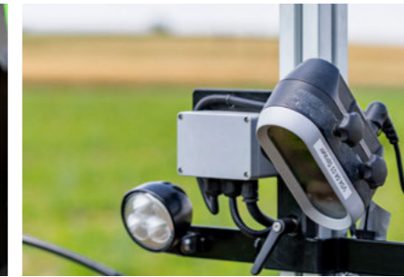
Система управления на базе камеры CultiCam с освещением для работы в сумерках и ночью
