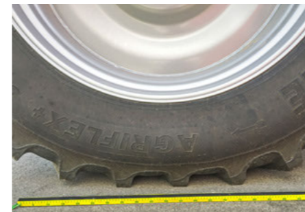
ATP Control: легкий ход с давлением в шинах 2,3 бар
