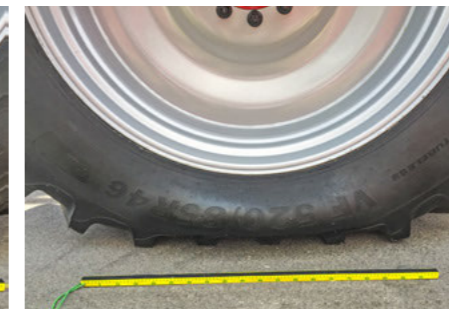
ATP Control: увеличенное пятно контакта с давлением в шинах 1,0 бар
