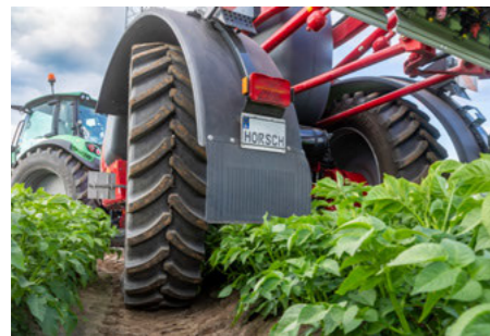
Управляемая ось с углом поворота колес до 28° даже с широкопрофильными шинами
