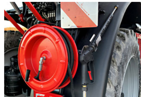
Гидравлическая мойка высокого давления
