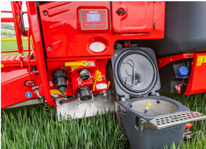
Rozwadniacz ze stali szlachetnej o pojemności 52 l i z dodatkową dyszą impulsową
