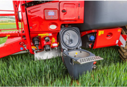
Rozwadniacz ze stali szlachetnej o pojemności 52 l i z dodatkową dyszą impulsową
