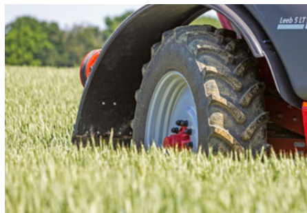
Oś skrętna z kątem skrętu do 28°, nawet przy szerokich oponach
