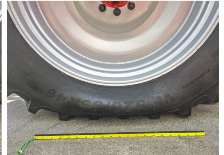
ATP Control – zwiększona powierzchnia przylegania przy ciśnieniu w oponach wynoszącym 1,0 bar
