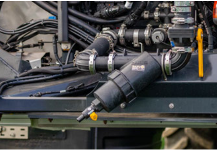
Drugi filtr ciśnieniowy w środkowej części belki
