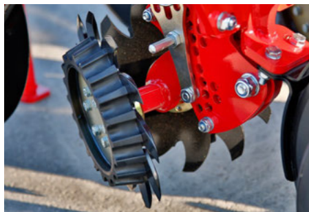
Optionale Räumsterne, schwimmend mit Tiefenführung
