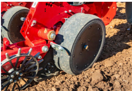
Standard Tiefenführungsrad für normale Bedingungen
