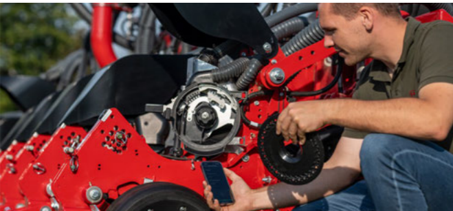
Die App HORSCH Assist mit der Funktion „Dosierscheibenwahl“ unterstützt bei der Auswahl der optimalen Dosierscheibe für jeden Einsatzzweck
