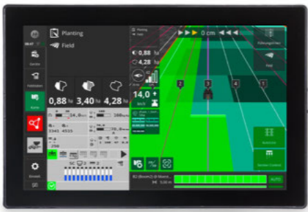
Mit Einzelkornsätechnik und HORSCH AutoLine lassen sich Fahrgassen gänzlich flexibel und unabhängig von der Fahrtrichtung GPS-gestützt säen
