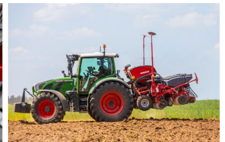
Maestro TX ausgehoben am Vorgewende
