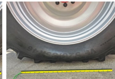
ATP Control – megnövelt érintkezési felület 1,0 bar abroncsnyomásnál
