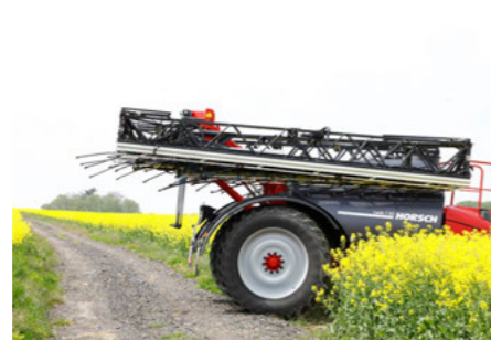
Connect & Fold rendszer – alkalmas kereskedelmi forgalomban kapható Droplegs-hez
