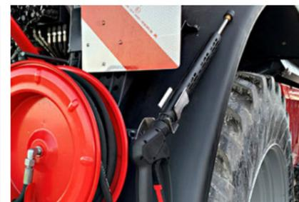
Nettoyeur haute pression à entraînement hydraulique
