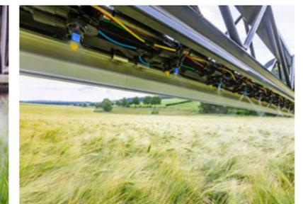
Ouverture pneumatique des buses et des tronçons
