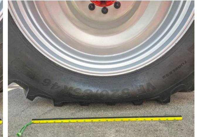
ATP Control- surface de contact plus importante à une pression de 1,0 bar
