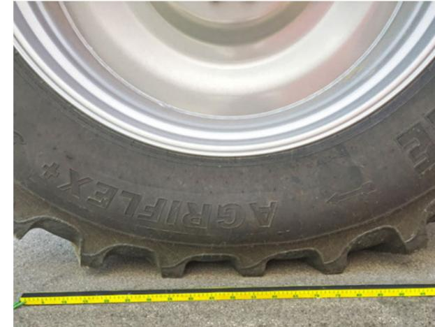
ATP Control – fonctionnement avec une pression des pneus de 2,3 bars
