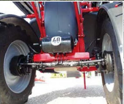
Hay tres versiones de suspensión disponibles sin suspensión, con amortiguador de elastómero y con suspensión neumática
