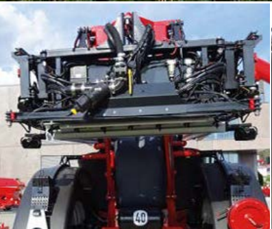
Sección central de la barra para una anchura de trabajo de 18 a 30 metros, disponible opcionalmente con bastidor pivotante.
