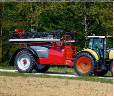
La barra no llega al frontal hacia la cabina del tractor
