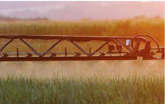
BoomControl – control automático de la altura mediante sensores de ultrasonidos
