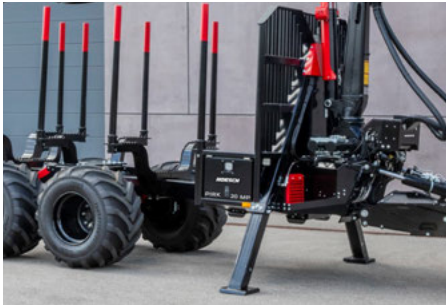
Im Stirngitter integrierte A-Säulenabstützung
