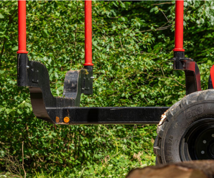
Schubheck vollständig ausgefahren
