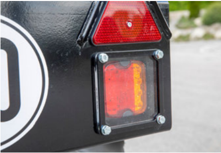
Geschützt verbaute Beleuchtungseinrichtung
