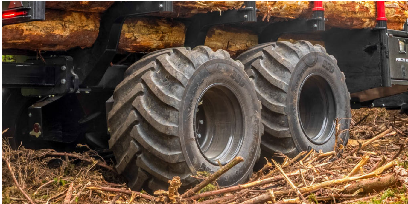
Bogie Fahrwerk mit bis zu \pm 20^\circ Schwenkbereich
