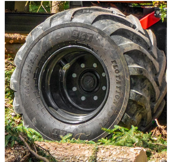
BlackBruin Radantrieb an der Hinterachse an einem Pirk 20 MP Rückewagen
