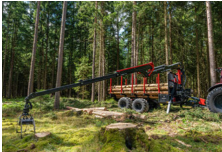
IB 9800.L10 mit bis zu 10 m Reichweite und 2,2 t Hubkraft bei 4 m Ausladung
