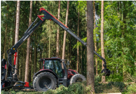
Schwenkbereich bis 400° ermöglicht auch das Arbeiten vor oder neben dem Traktor
