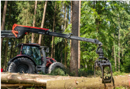
Alle Kräne verfügen über einen Doppelteleskopausschub
