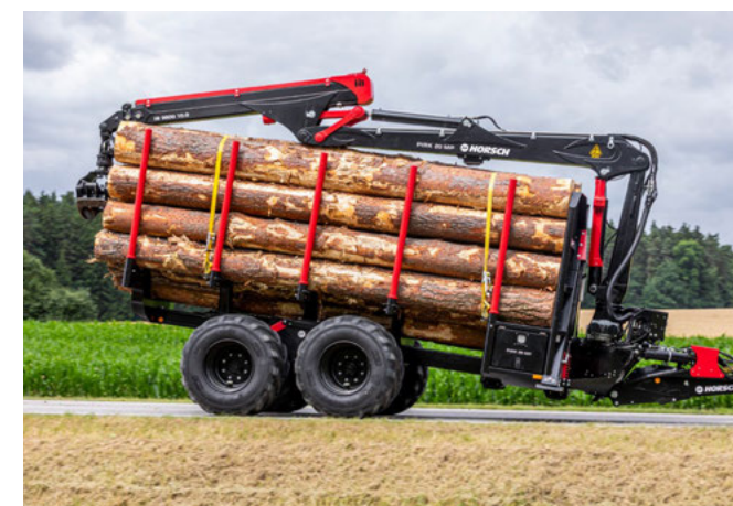
Durch Absenken bis zum Endanschlag wird die Deichsel gegen seitliches Verfahren gesichert
