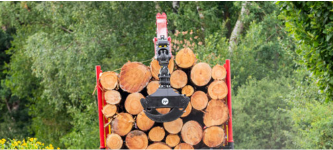
Beim Straßentransport hängt der Greifer hinter dem Wagen
