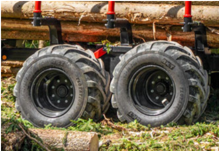
Bereifung bis 710 mm Breite und 117 cm Durchmesser
