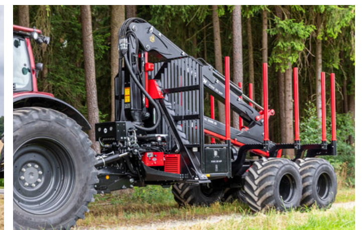
Auf Feld- und Waldwegen wird der Wagen über die hydraulische Deichsel für mehr Bodenfreiheit angehoben
