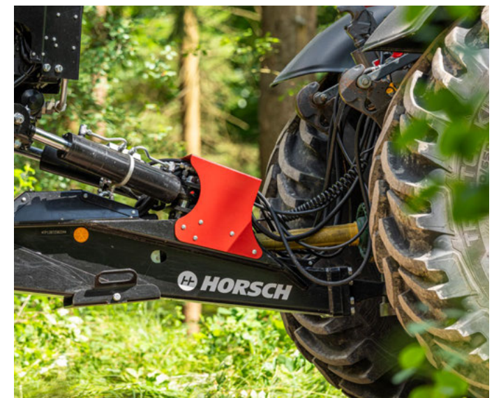
In Deichsel geschützt verbaute Zapfwellenpumpe zum Antrieb der Bordhydraulik
