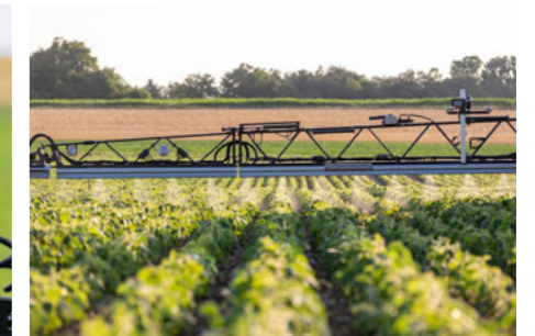
Effektivní pásová aplikace přímo na řádek rostlin s volitelným kamerovým řízením
