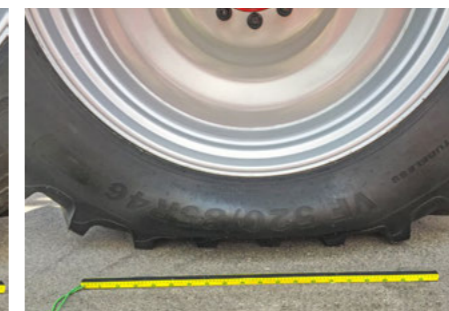
ATP Control – zvětšená styčná plocha při tlaku v pneumatikách 1,0 bar
