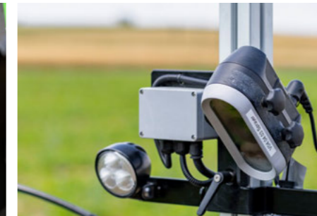
Kamerové řízení CultiCam s osvětlovacím balíčkem pro práci za obtížných světelných podmínek
