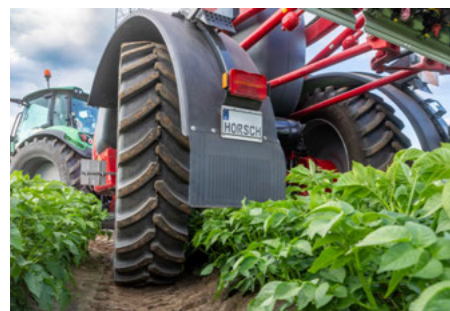
Říditelná náprava s úhlem natočení kol až 28° i při širokých pneumatikách
