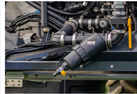
Druhý tlakový filtr na středové části ramen
