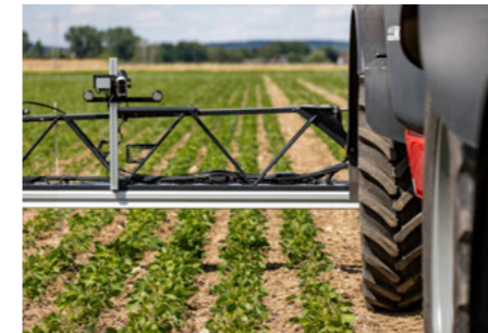
Vysoce přesné řízení taženého postřikovače s CultiCam
