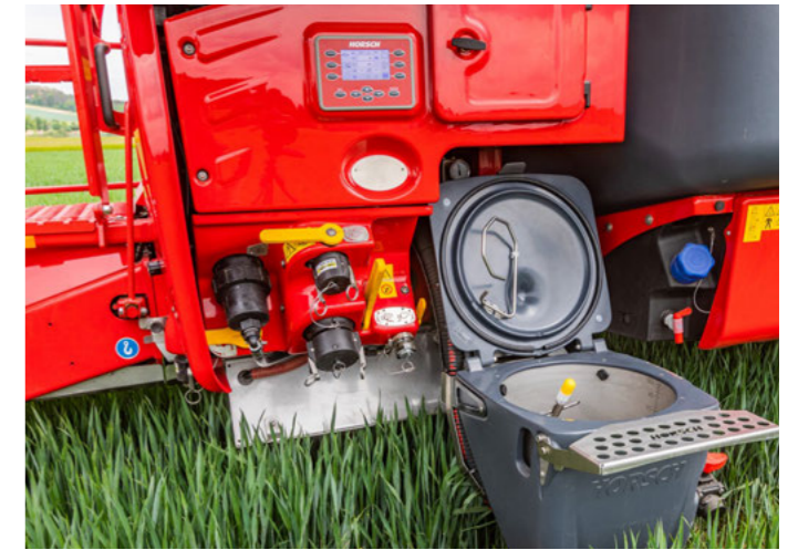
52 l nerezová přimíchávací nádoba včetně přidavné míchací trysky
