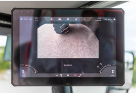
Affichage haute résolution et individuel de la caméra de la roue avant droite sur l’écran du montant avant droit
