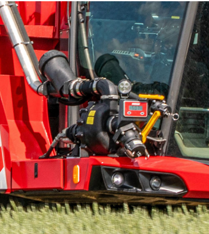
Pompe de remplissage PowerFill avec une capacité de 1 000 l/min – raccord de remplissage Camlock 3” à l’avant et écran
