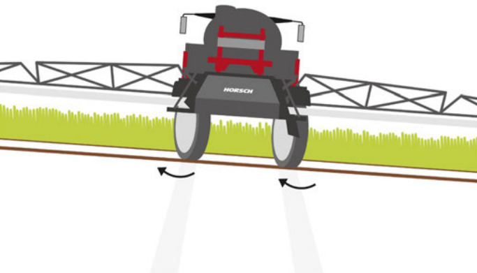
Le contre-braquage actif en pente, HillControl, compense la dérive dans les dévers et assure le suivi précis de l'essieu arrière
