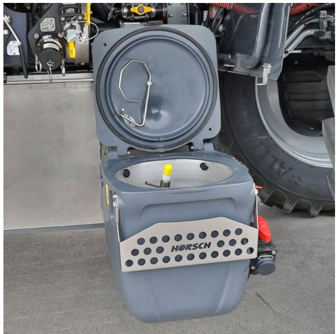
Bac d'incorporation en inox de 52 l avec buse de poussée supplémentaire
