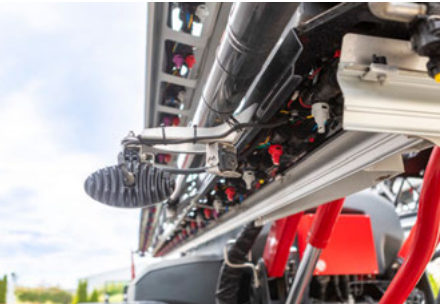
Caméra pour la surveillance des buses sur le support NightLight
