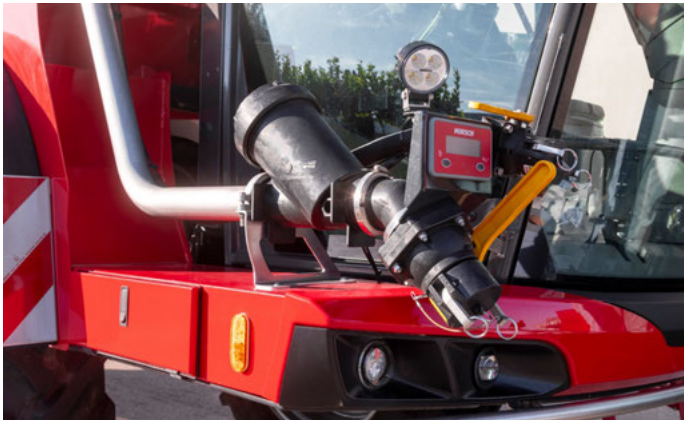
Raccord de remplissage externe 3" avec filtre à côté de la cabine
