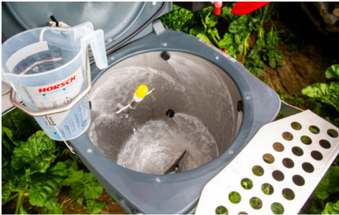
Incorporateur en acier inoxydable de 52 l, incluant une buse de poussée supplémentaire.
