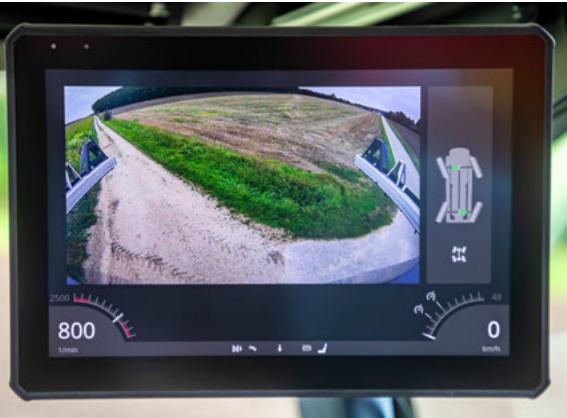
Affichage automatique haute résolution de la caméra de recul sur l’écran du montant avant droit
