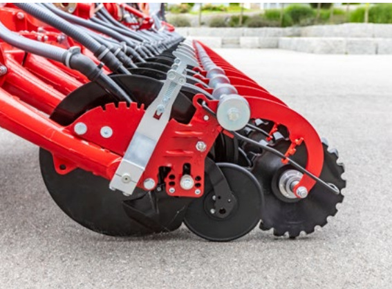
Rueda de cierre estrellada de acero – produce tierra fina y cierra el surco de siembra
