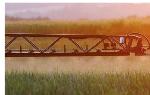
BoomControl – автоматическое ведение штанги по высоте с использованием ультразвуковых датчиков
