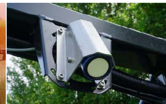
Дополнительное оснащение еще двумя ультразвуковыми датчиками
