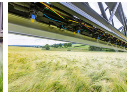
Pneumatyczne przełączanie dysz i szerokości częściowych
