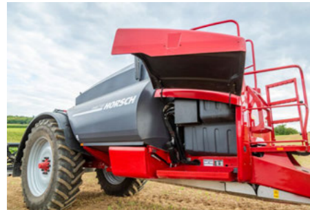
Opcjonalnie: schowek na pojemniki pod prawą klapą opryskiwacza
