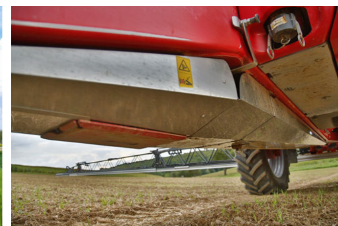
Gładkie podwozie maszyny chroni łan
