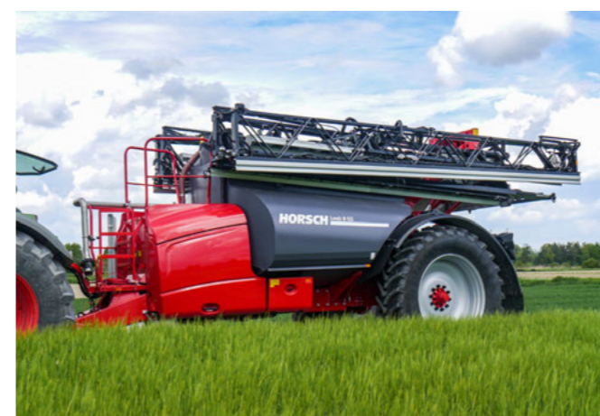
Kompaktowe składanie/rozkładanie 7-segmentowej belki
