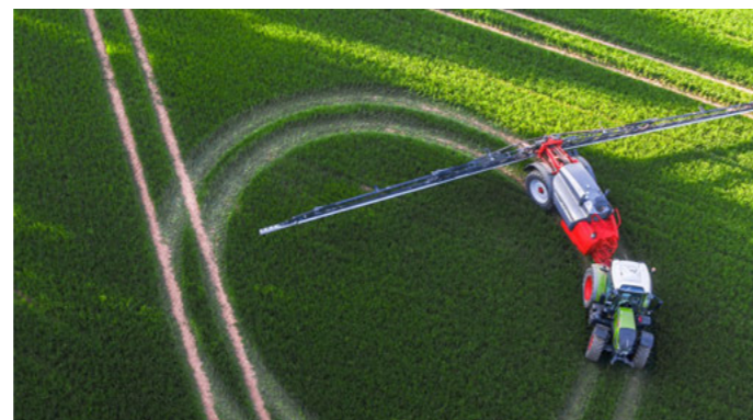
Maksymalna ochrona upraw i poruszanie się kół opryskiwacza dokładnie w śladzie ciągnika
