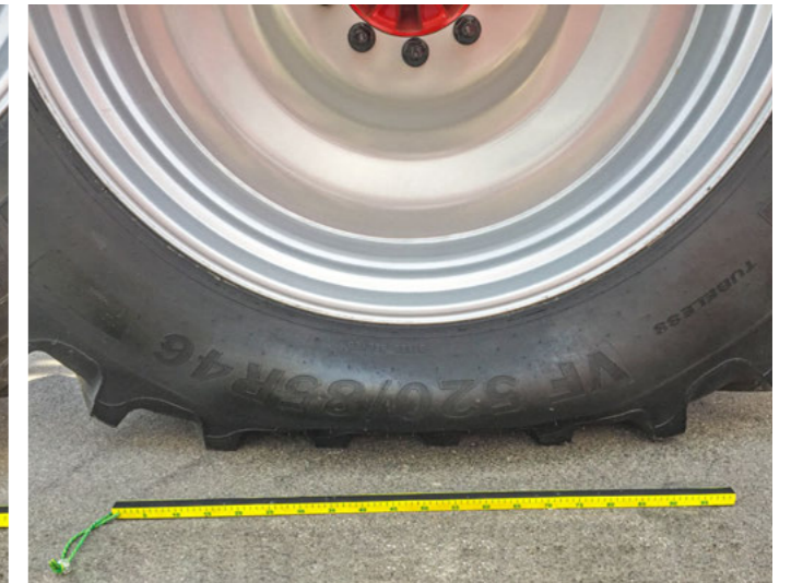
ATP Control – zwiększona powierzchnia przylegania przy ciśnieniu w oponach wynoszącym 1,0 bar
