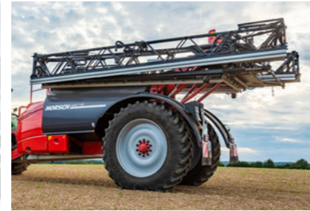
Ogumienie Ø 2,07 m zapewnia maksymalny prześwit i dużą powierzchnię przylegania
