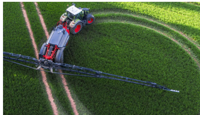
Kormányzott tengely akár 28°-os bekormányzási szöggel még széles gumibroncsok esetén is
