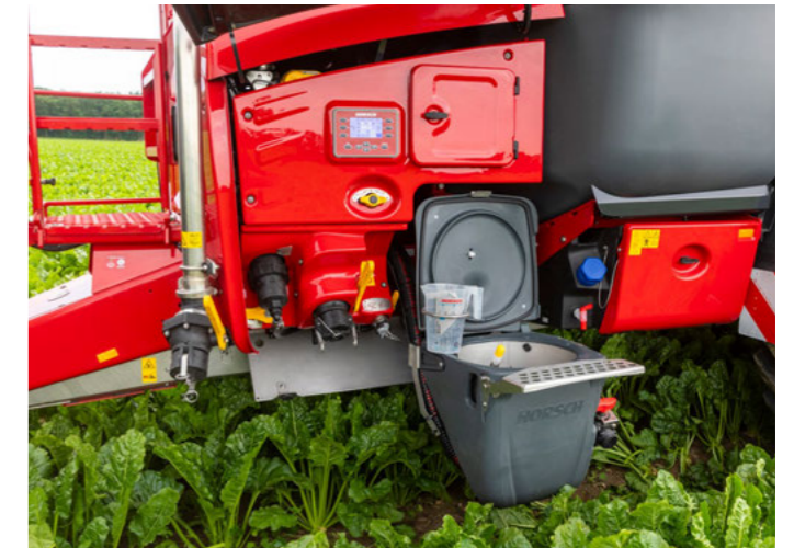
Intuitív feltöltőközpont 3" külső feltöltéssel és nagy teljesítményű vegyszerbekeverővel
