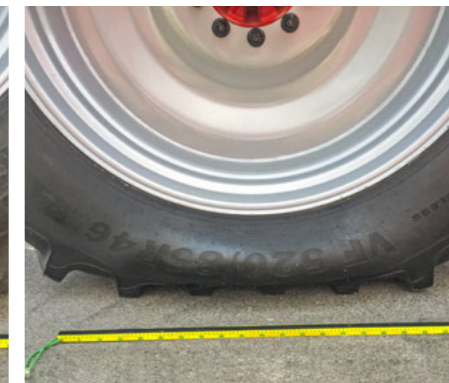
ATP Control – Megnövelt felfekvőfelület 1,0bar nyomásnál
