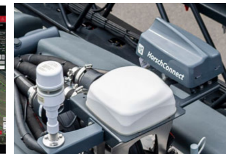
Digitális hálózat HorschConnect-tel, GPS és egy meteorológiai állomás segítségével az aktuális környezeti feltételekhez való optimális alkalmazkodás érdekében
