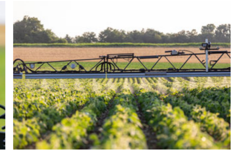
Hatékony sávpermetezés a fűvókával közvetlenül a növény sor felett, opcionális kameravezérléssel
