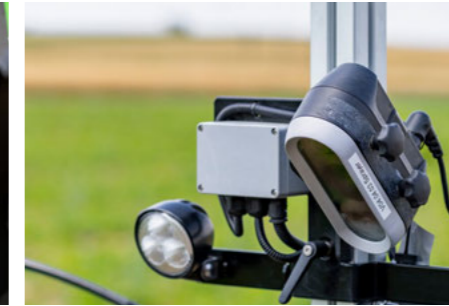
CultiCam Kameravezérlés világításcsomaggal a nehéz fényviszonyok közötti munkavégzéshez
