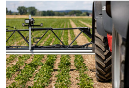
Nagy pontosságú vontatott permetezőgép irányítás CultiCam segítségével
