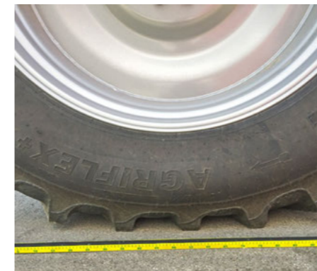
ATP Control – könnyed futás 2,3bar guminyomással
