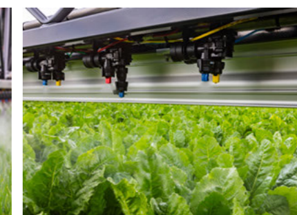
Pneumatické ovládní trysek a sekční ovládní
