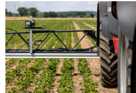
Vysoce přesné řízení taženého postřikovače s CultiCam
