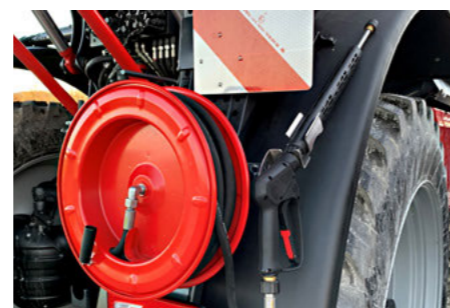
Hydraulicky poháněný vysokotlaký čistič
