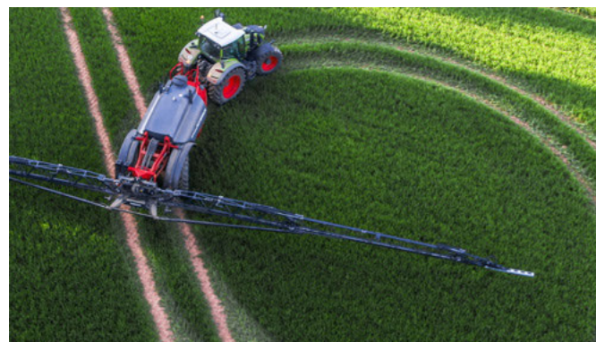
Říditelná náprava s úhlem natočení kol až 28° i při širokých pneumatikách
