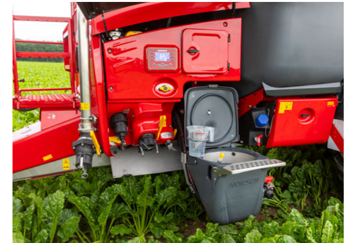
Intuitivní plnicí centrum s 3" přípojkou pro vnější plnění a výkonnou přimíchávací nádobou
