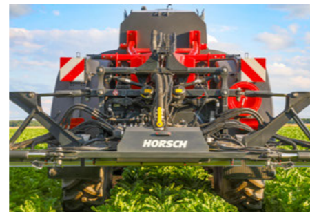
Robustní střední část ramen s kyvným rámem a spojovací tyčí
