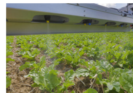
Pásová aplikace nepředstavuje při rozestupu trysek 25 cm žádný problém.
