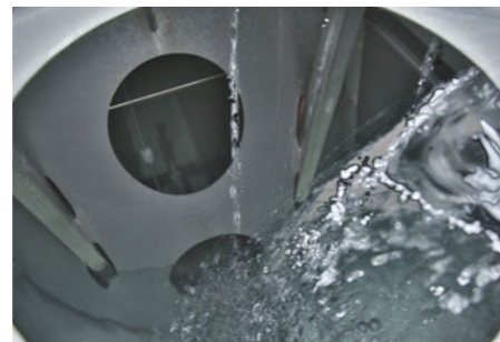
Snadné čištění, stěny nádrže bez přepážek
