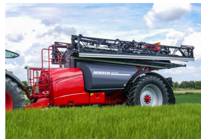
Kompaktní sklápění sedmidílných ramen
