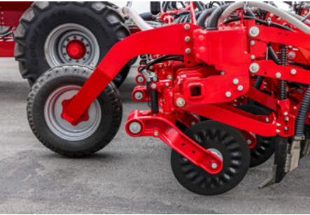
Sistema de corte con control de presión hidráulica
