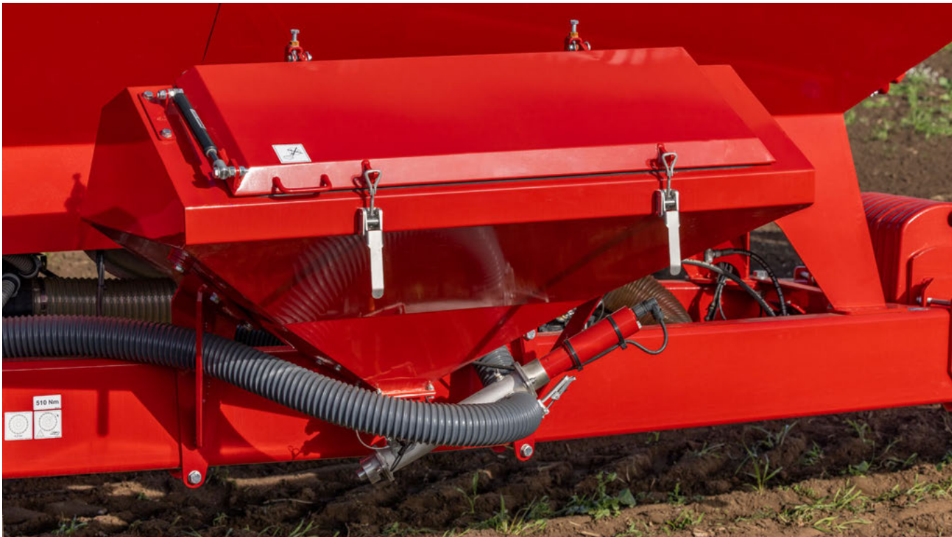
Caja microgranuladora para siembra intercalada o aplicaciones de otros insumos
