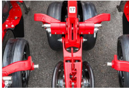
Línea de siembra con brazo externo y muchas opciones de ajustes.
