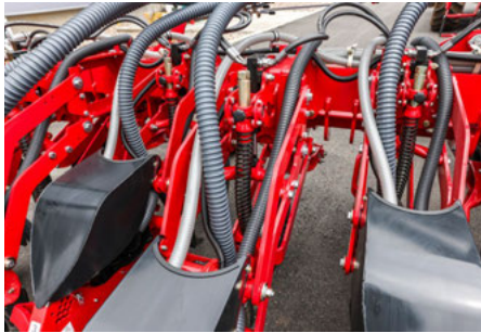
Sistema pantográfico con presión hidráulica en la línea de siembra
