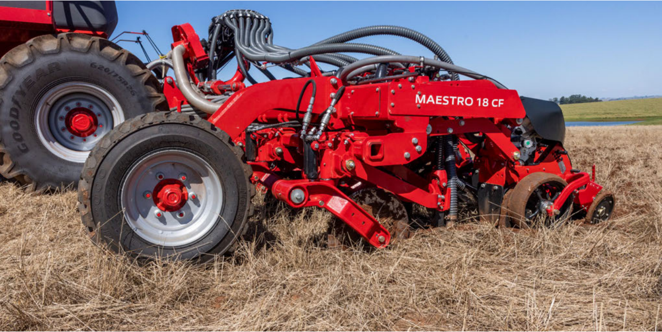
Línea de siembra con presión hidráulica en el corte y pantógrafo
