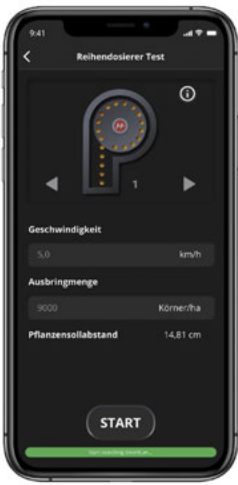
A través de la aplicación MobileControl, se puede realizar la prueba de los parámetros más importantes de la calidad de singulación en cualquier momento.
