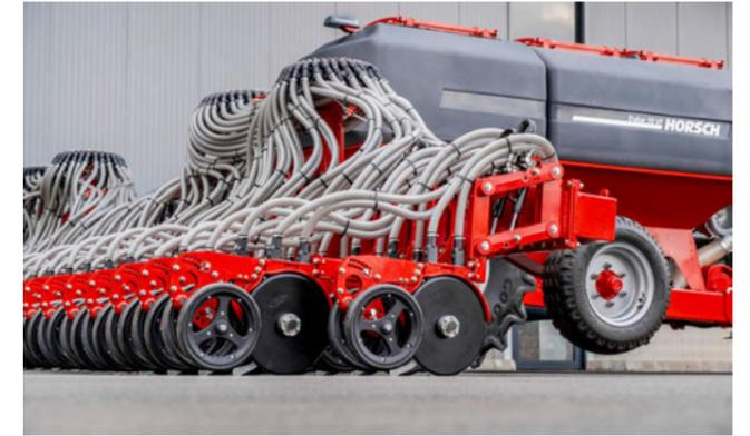
Línea pantográfica con presión hidráulica
