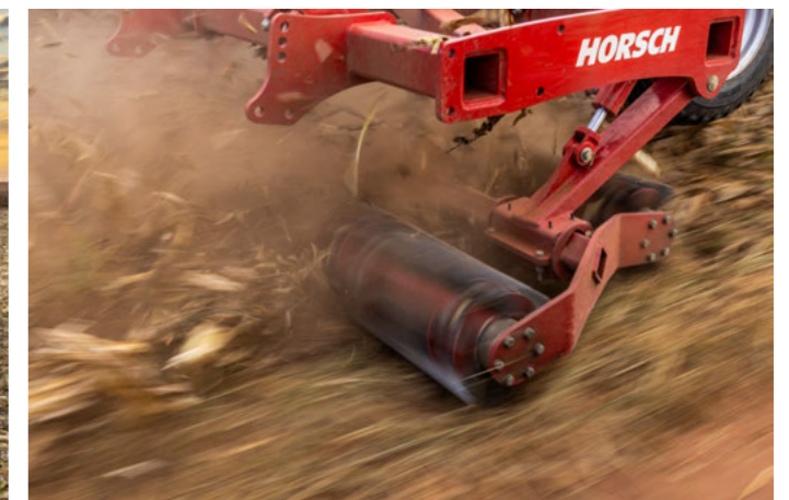
La suspensión de goma hace que los dos rodillos realicen la copia del relieve.
