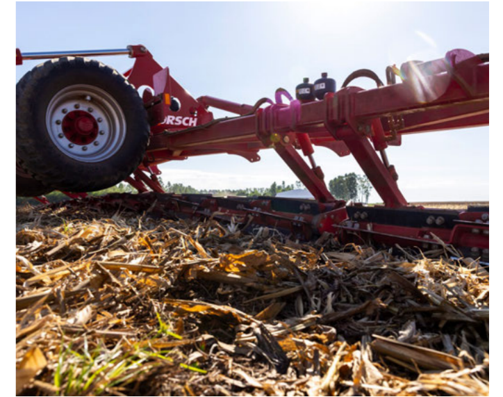
Sistema hidráulico de transferencia de peso y absorción de impactos
