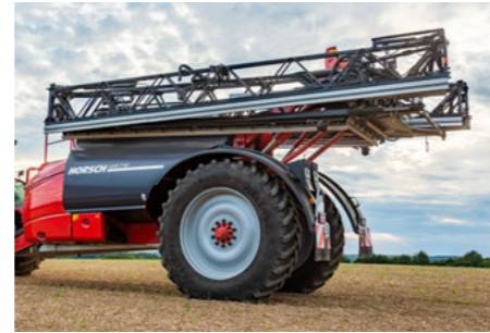
Pneumatiques de Ø 2,07 m pour un dégagement et une surface d'appui maximales
