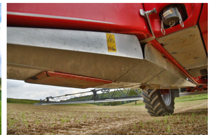
Carénage sous le châssis parfaitement lisse et respectueux des cultures
