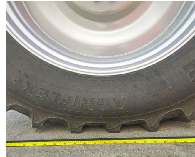
ATP Control – fonctionnement avec une pression des pneus de 2,3 bars
