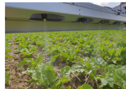
L'application en bandes est également possible grâce à la répartition à 25 cm
