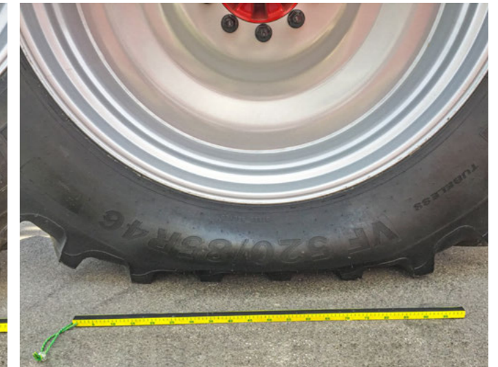
ATP Control- surface de contact plus importante à une pression de 1,0 bar
