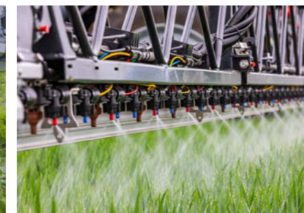
Espacement entre buses de 25 cm : plus de buses, plus d'options, par ex. application 3D
