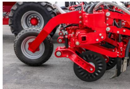
Sistema de corte com controle de pressão hidráulica
