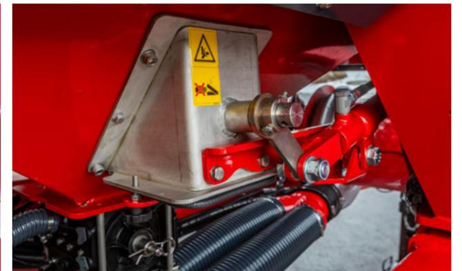
Eixo agitador de fertilizante fora do tanque
