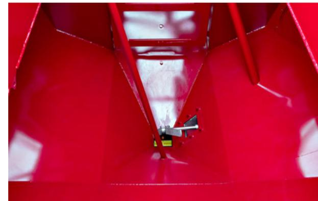
Eixo agitador de fertilizante dentro do tanque
