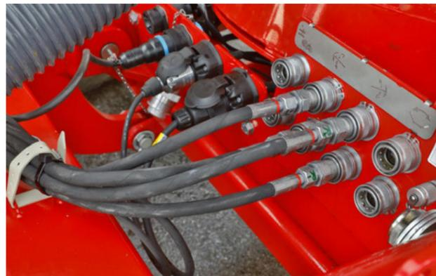
Engate rápido nas conexões hidráulicas
