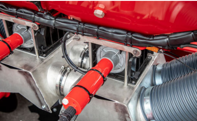
Motor elétrico de dosagem
