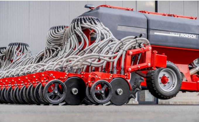
Linha pantográfica com pressão hidráulica
