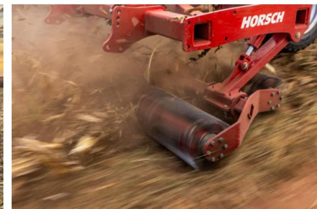
Suspensão de borracha faz com que os dois rolos realizem a cópia do relevo
