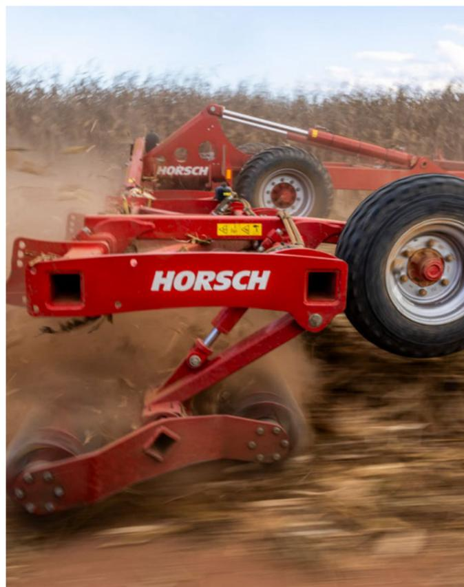
Possui rolamentos blindados e às facas apoiadas nos rolos, o rolo faca duplo é extremamente robusto. Devido à suspensão oscilante de borracha, o rolo faca pode se adaptar de forma otimizada às irregularidades e garantir um excelente corte.
