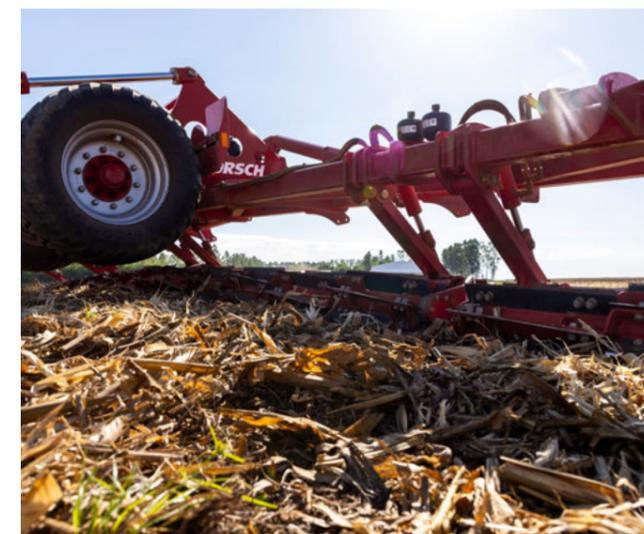
Sistema hidráulico de transferência de peso e absorvendo impactos
