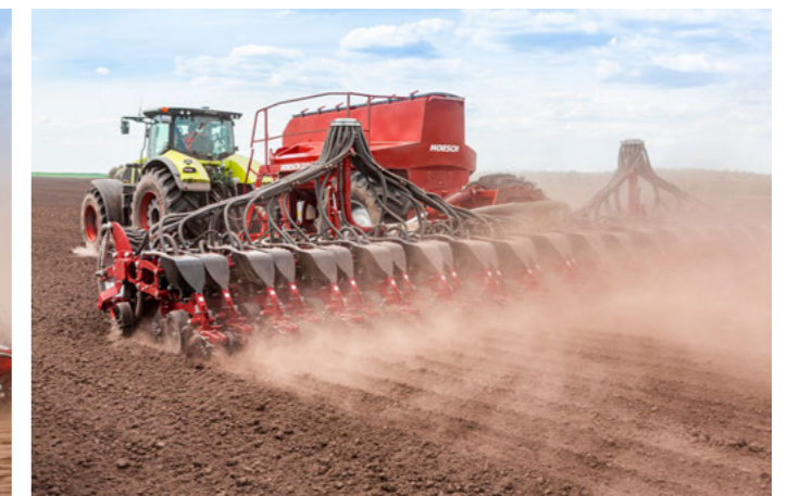
Гідравлічне притискне зусилля сошників до 350 кг для якісної сівби навіть за складних умов
