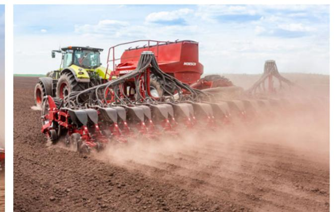
Hydraulischer Schardruck bis 350 kg für eine zuverlässige Aussaat auch unter schweren Bedingungen
