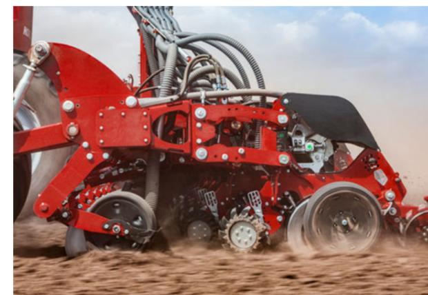
Breites Parallelogramm mit groß dimensionierten Buchsen für gute Stabilität und lange Haltbarkeit
