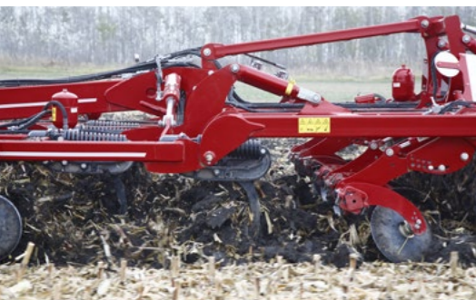
Система стійок TerraGrip Інтенсивне розпушування і перемішування завдяки дворядному розміщенню робочих органів
