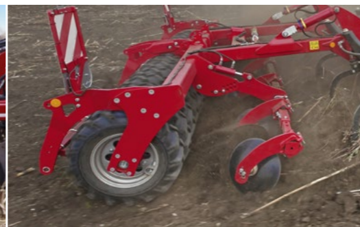
Вирівнювальні диски Рівномірне вирівнювання перед колісним котком
