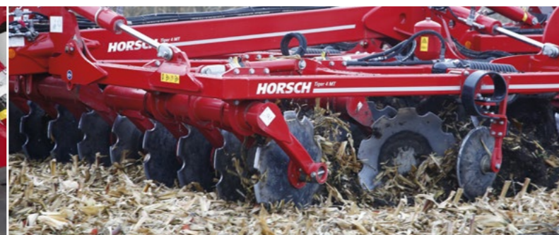
Важка система дисків (DiscSystem) Дворядне розміщення, діаметр дисків 68 см, відстань між дисками 40 см, диски з великими вирізами й індивідуальним кріпленням
