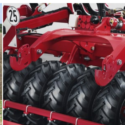
Задня навіска на рамі Tiger з роз'ємами для підключення гідро- та електричних систем
