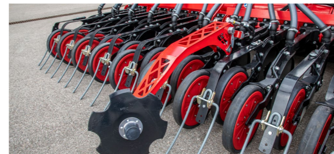
Die Aggressivität des Voraufmarkierers wird über einen Tiefenschlag eingestellt
