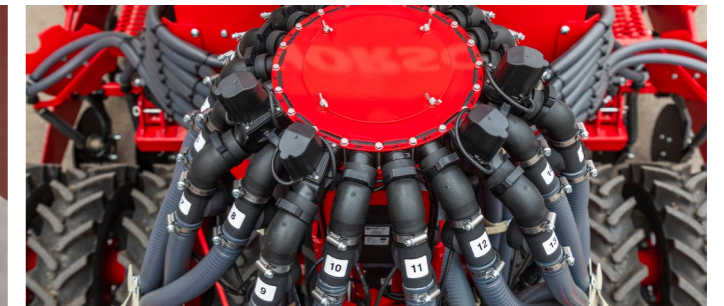
Überwachung des Pneumatikdurchflusses am Verteilerturm
