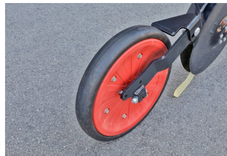
5 cm breite Andruckrolle – ideal auf mittleren bis schweren Böden
