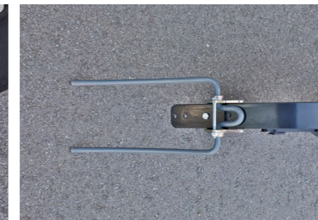
Der gerade Striegel – TurboDisc-Säschar wird für eine effizientere Bodenbearbeitung einzelschargeführt
