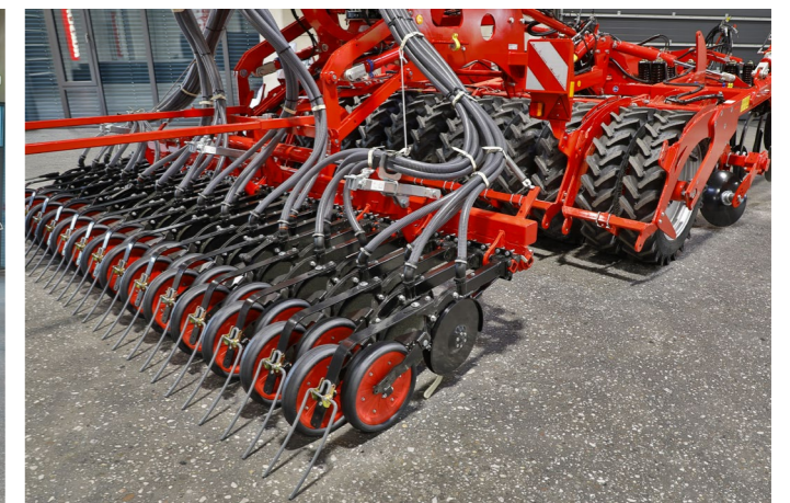
TurboDisc Säschar für präzise Saatgutablage und hohe Scharldrücke
