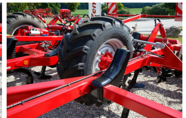
Roues de grande dimension assurant le transport sur route et le contrôle de terrage en l'absence de rouleau
