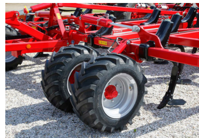
Option : roues de support frontales doubles pour les sols légers
