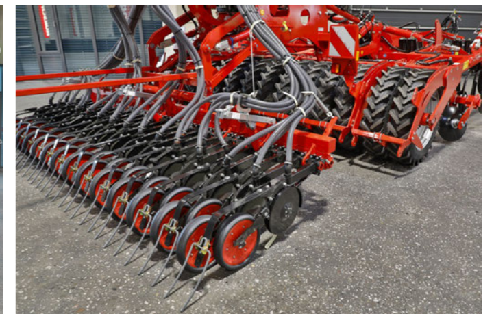
Élément semeur TurboDisc pour un placement précis de la semence et une pression élevée sur les éléments semeurs
