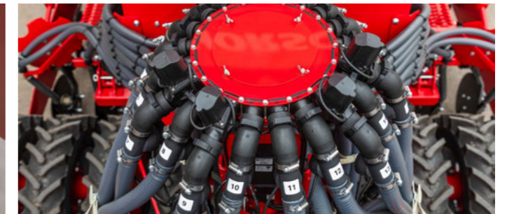
Contrôle du flux pneumatique sur la tête de répartition
