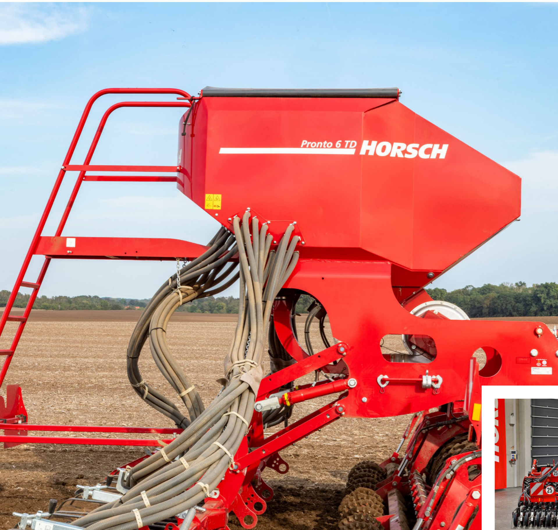
Accessibilité à la trémie de semences facilitée grâce à la rampe d'accès largement dimensionnée
